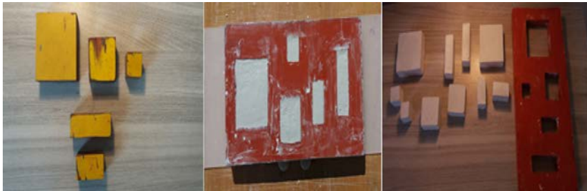
Figura 9: Matrizes em madeira e peças criadas em molde de silicone
