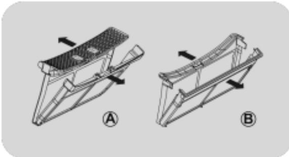
3. Retirez délicatement les peluches des deux filtres à l'aide de vos doigts ou d'une brosse douce, d'un chiffon ou sous l'eau courante.
