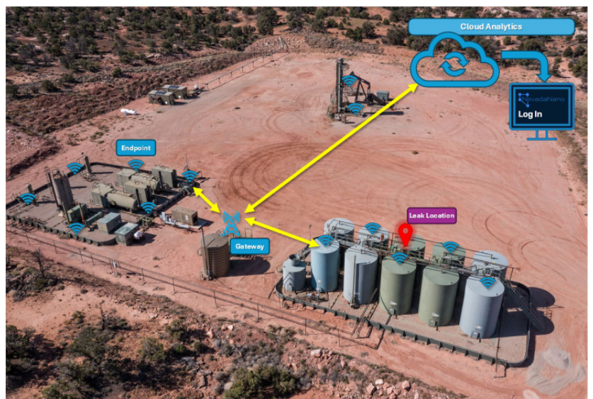
Una instalación típica de O&G aguas arriba
