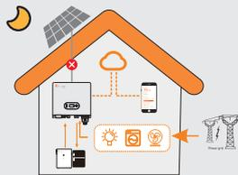
**Mode 3:** Wenn das Netz ausfällt, schaltet das System automatisch in den Back-Up-Modus. Die Back-Up-Last kann durch PV und Batterie aufgeladen werden.
