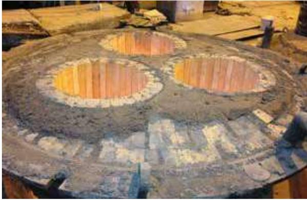
Delta para bóveda de un horno de arco eléctrico
