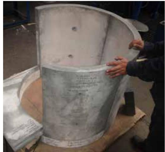
Ducto resistente a la abrasión en Nitro sic 21
