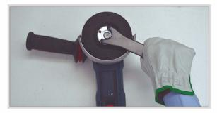
NUNCA use bridas o tornillos de montaje dañados,
