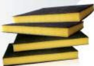
Acabado intermedio y final de madera en blanco. Limpieza y acabado de metales, acero inoxidable y al carbón, aluminio, bronce y hierro, entre otros. Lijado y acabado de superficies de plástico curvas. Ambas caras pueden ser utilizadas. Gran flexibilidad que se adapta a cualquier superficie. Ideal para trabajo en superficies húmedas o secas. La esponja puede ser lavada, secada y reutilizada.
