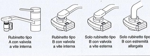
Rubinetto tipo A con valvola a vite interna
