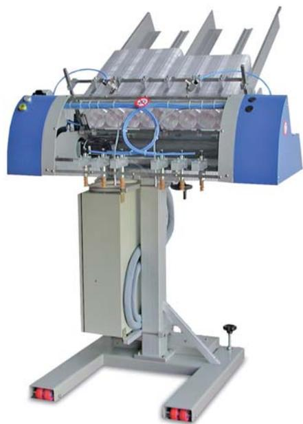
Il sistema è disponibile interamente in acciaio Inox e alluminio anodizzato, con doppio magazzino di carico per vaschette a fondo piatto o alveolari. È movimentato da un motore Brushless e raggiunge una produzione di 160 pz/min a 80 cicli. Progettato per essere integrato sulle confezionatrici Flowpack, o come alimentatore dei nastri trasportatori che convogliano al riempimento manuale.
