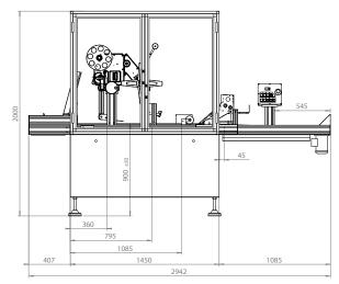
Sistema di etichettatura automatico concepito per movimentare, etichettare, codificare a seconda delle esigenze, ad alta velocità astucci stesi per il settore farmaceutico. Il sistema è disponibile nella versione con movimentazione alternata o continua, e supporta infatti sfogliatori, etichettatrici e gruppi stampa per distribuire, etichettare e stampare i prodotti, nonchè sistemi di visione per la lettura e verifica dei dati con espulsione dei prodotti non idonei.
