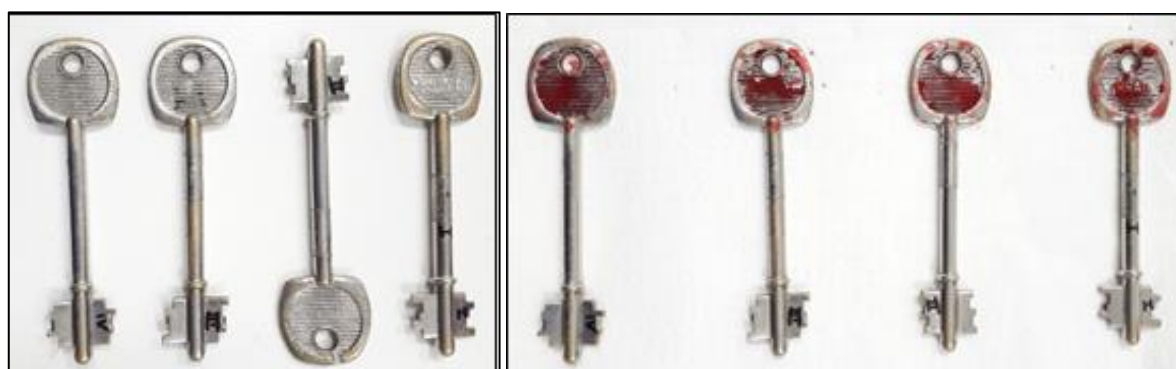
Figura 7. Soporte de superficie metálica y acanalada, puesto en contacto con la muestra de referencia
