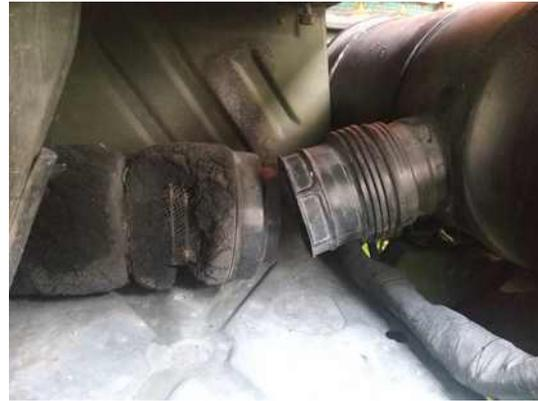
**Pour insérer le neuf, il faut comprimer légèrement les 40 premières centimètres jusqu'à le mettre au fond**
