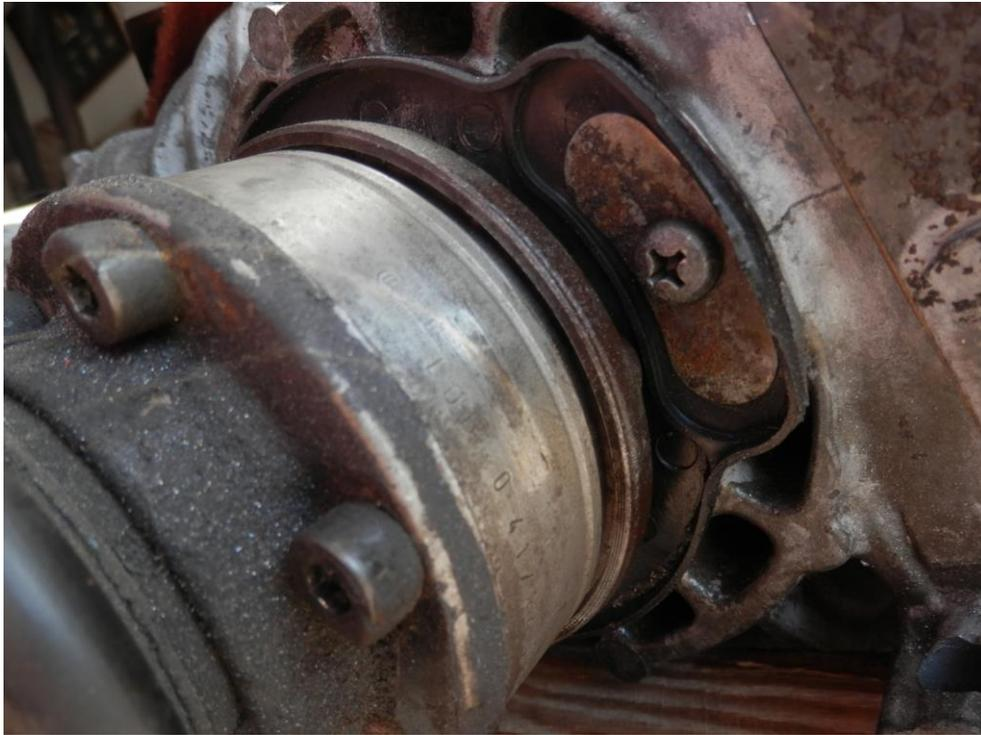
Si on veut protéger les joints homocinétiques et en même temps notre portefeuille, un après-midi où on s'ennuie, on démonte un arbre de transmission et même sans démonter les joints homocinétiques ni démonter les billes ou quoi que ce soit, on enlève le cache poussière vers l'arrière et de cette façon, nous pouvons bien le nettoyer avec une brosse et du diesel, puis souffler tous les restes et relubrifier avec de la graisse au lithium (environ 80 ou 100 g par joint homocinétique)
