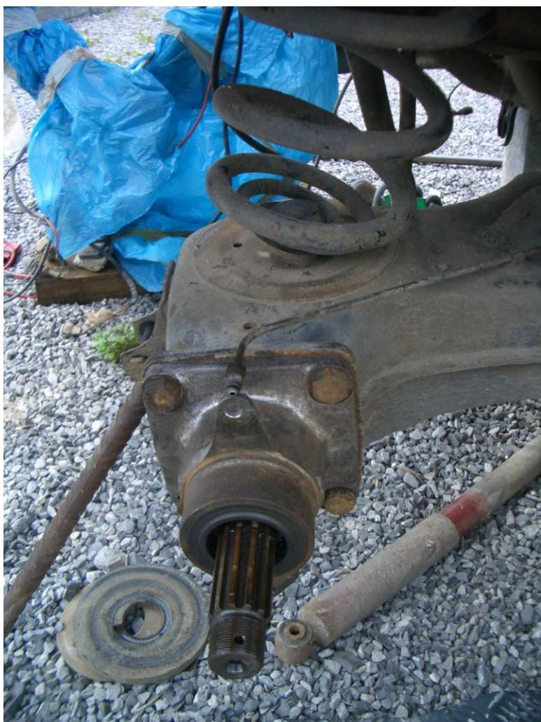
Nous plaçons la plaque (comme sur la photo) et mettons les vis: Deux M8 avec écrou et deux M10.
