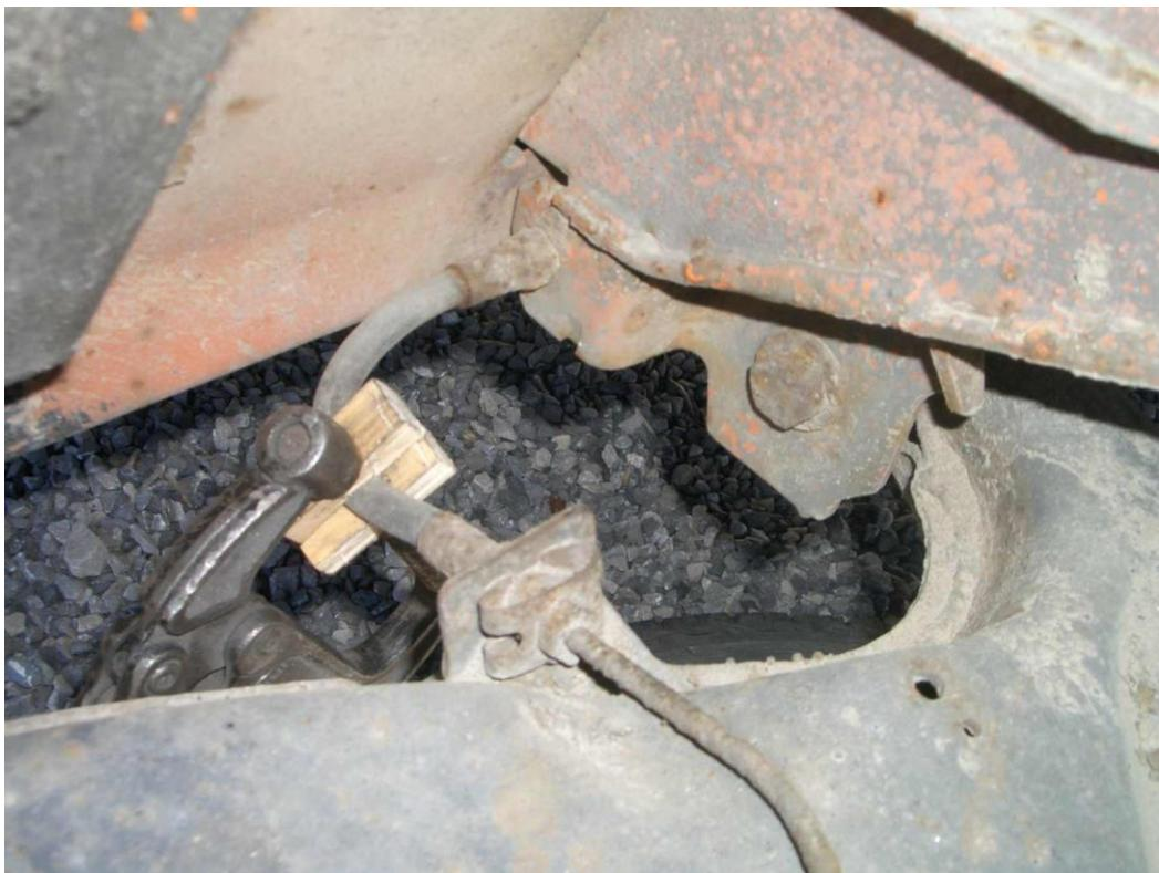
On desserre deux vis en dessous, clé de 17 mm
