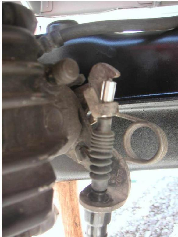
On passe le câble sous le bras de suspension, on le fixe avec le clip, on le passe à travers son guide-butée en plastique et on l'amène au distributeur-tendeur, où on a préalablement placé une douille, car les nouveaux câbles sont un peu plus longs.
