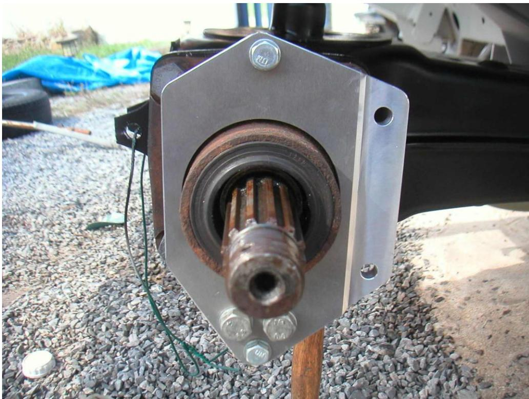
Maintenant, nous plaçons le moyeu rectifié (**le diamètre doit être réduit à 145,9 mm pour s'adapter au disque**), le disque (nous le tenons avec deux écrous) et l'étrier.
