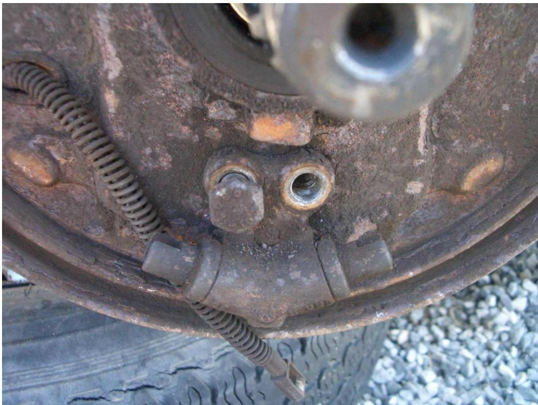
Derrière, en haut, on retrouve le frigide. Il faut le desserrer avec une clé de 11 mm Juste en dessous on trouve une vis de 13 mm qu'il faut retirer pour enlever le cylindre de frein.
