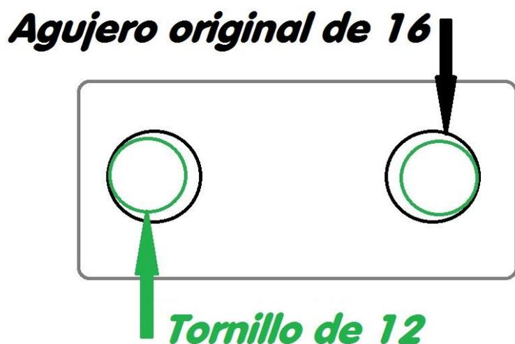
Entre la pinza y la mangueta hay que intercalar unas arandelas calibradas para ajustar el desplazamiento. En realidad todo el kit se resume en ésto:
