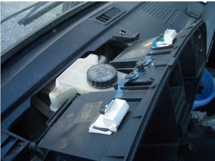
Wenn wir keinen Abfluss haben, können wir es zu zweit machen. Einer sitzt, überwacht den Füllstand und füllt bei Bedarf nach, während er das Pedal betätigt, und der andere kümmert sich um die Bremssättel.
