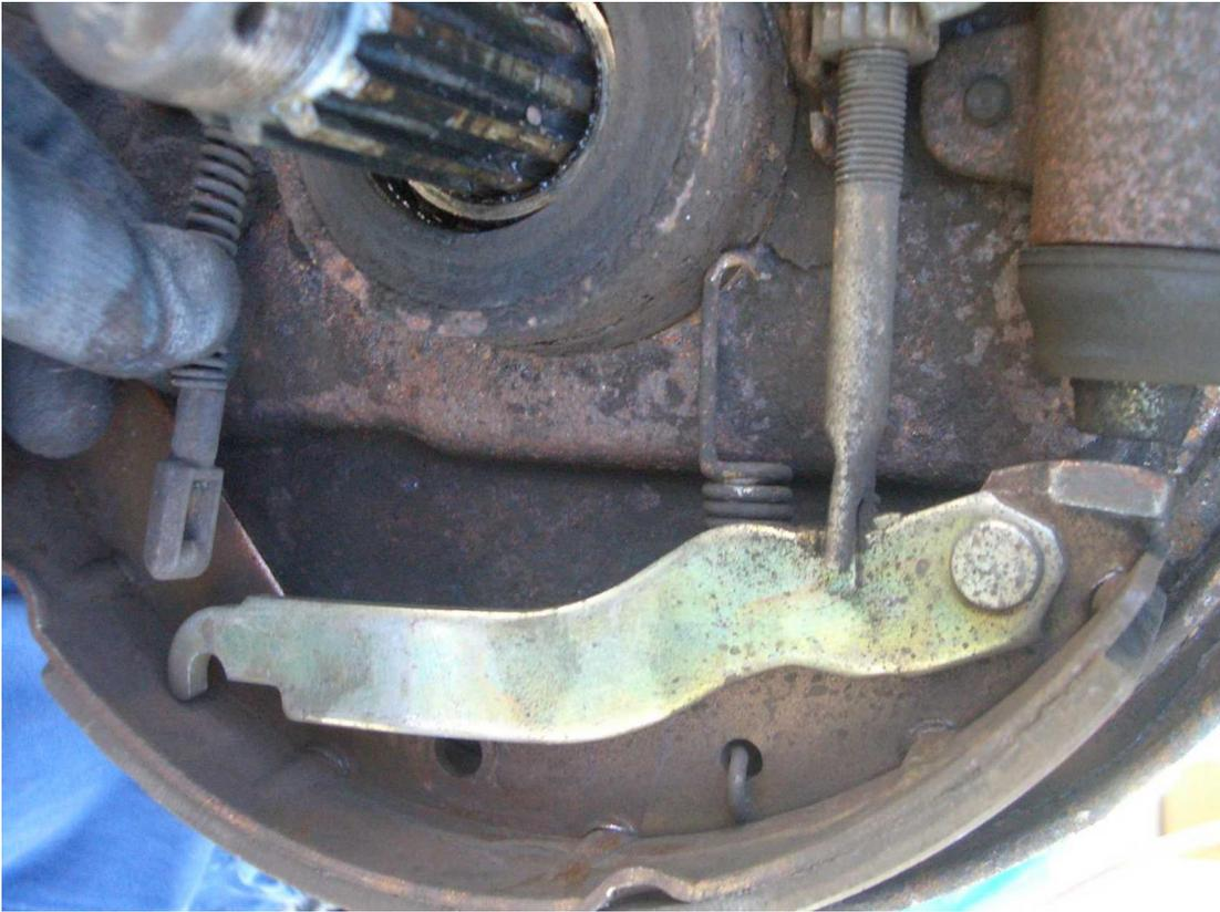
Wir lösen das Handbremsseil, alle Federn, die Federn, die Backen und belassen es wie folgt:
