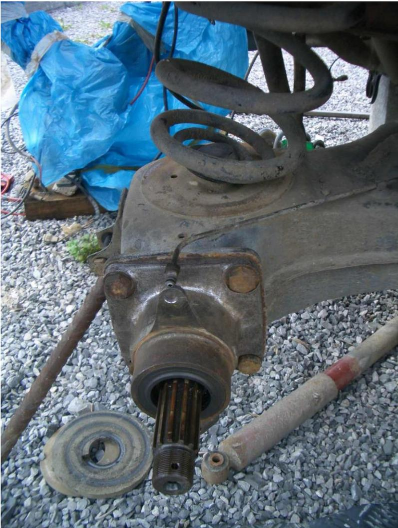
Wir platzieren die Platte (mit der Aussparung nach innen) und setzen die Schrauben ein: Zwei metrische 8er-Schrauben mit Mutter und zwei metrische 10er-Gewindeschrauben.
