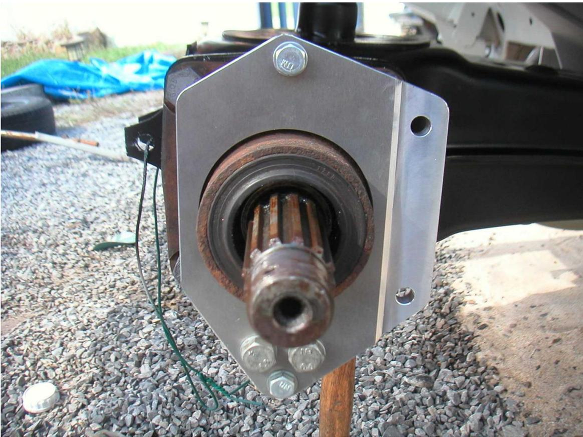
Jetzt platzieren wir die geschliffene Nabe (**der Durchmesser muss auf 145,9 mm reduziert werden, damit die Scheibe passt**), die Scheibe (wir halten sie mit ein paar Muttern) und setzen den Bremssattel ein.
