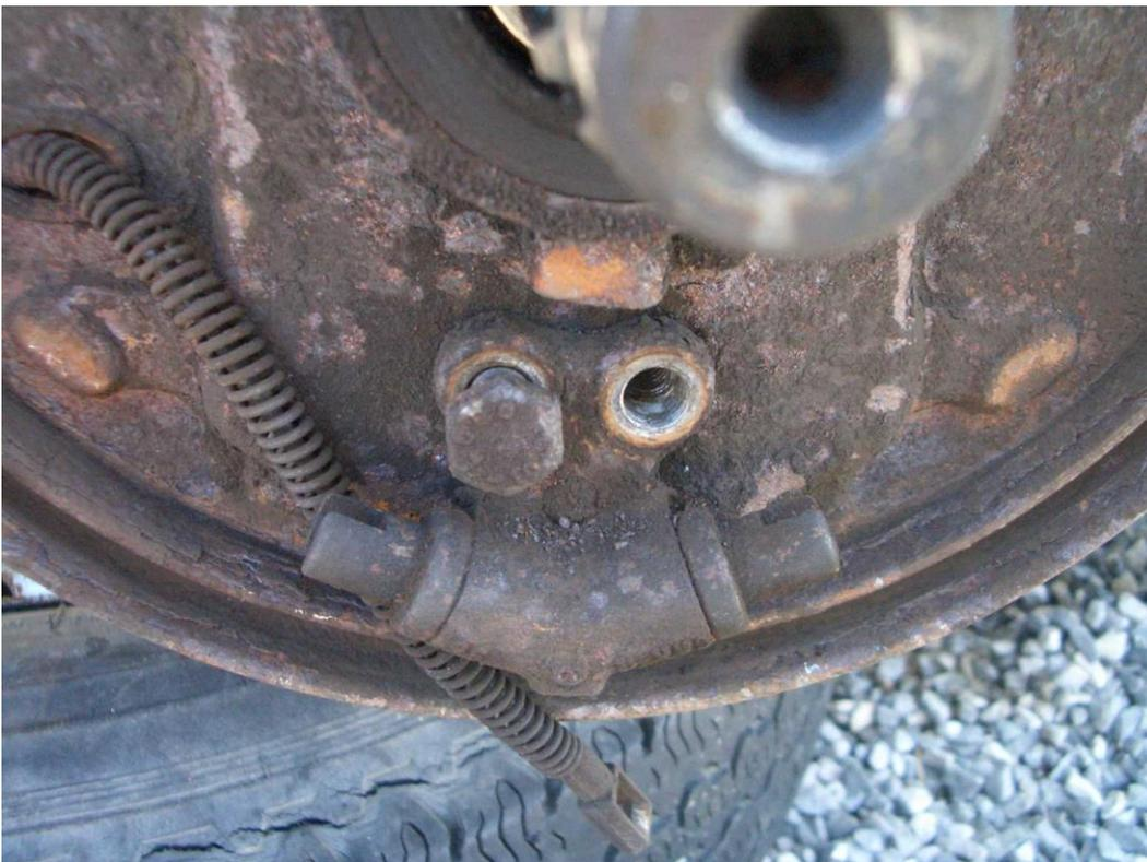
Hinten, oben, finden wir die Bremse starr. Sie muss mit einem 11-mm-Schraubenschlüssel gelöst werden. Direkt darunter finden wir eine 13-mm-Schraube, die entfernt werden muss, um den Bremszylinder zu entfernen.
