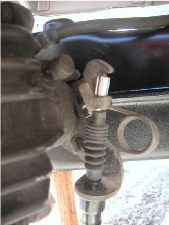
Wir führen das Kabel unter dem Aufhängungsarm durch, fixieren es mit der Klammer, führen es durch seinen Führungsanschlag aus Kunststoff und führen es zum Verteilerspanner, wo wir zuvor eine Buchse platziert haben, da die neuen Kabel etwas länger sind.
