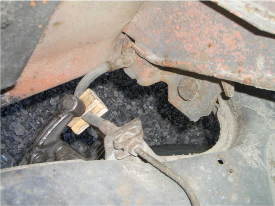
Wir lösen zwei Schrauben unten, 17-mm-Schraubenschlüssel
