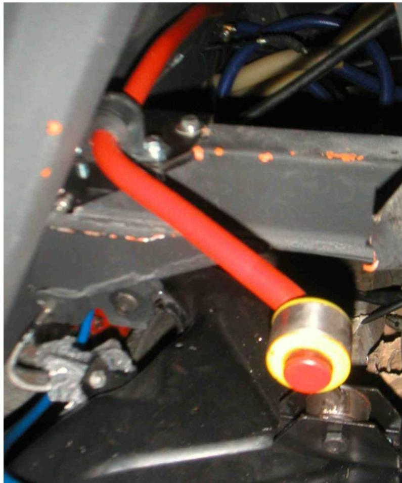
Y listo. Éste es el montaje definitivo... Se aprecia el amortiguador atornillado y el suplemento de 5m bajo la fijación inferior.
