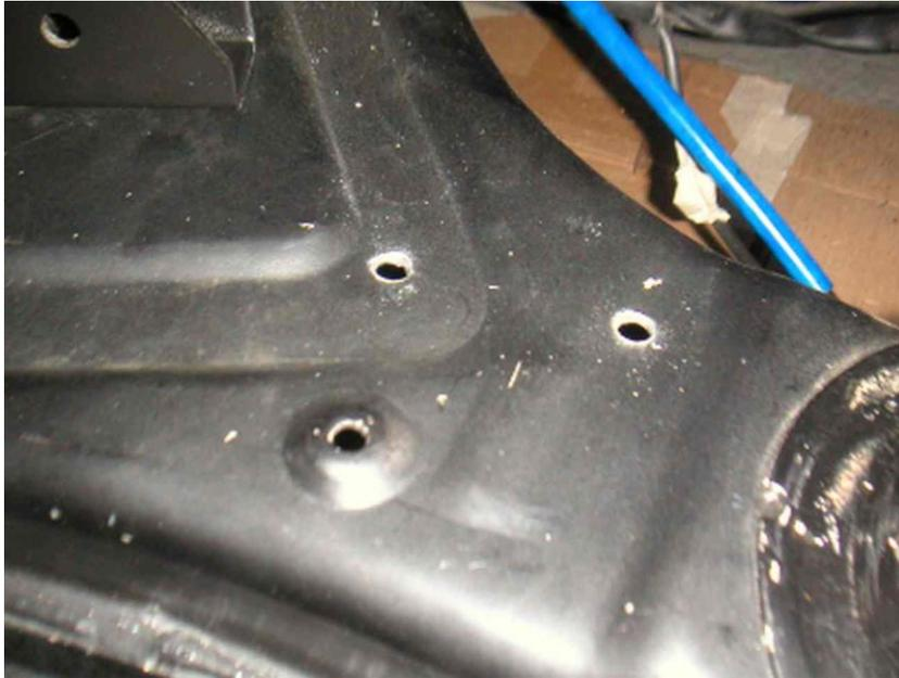
Después ponemos las pletinas de fijación. Las colocamos en su alojamiento, ponemos el tornillo superior, que lleva un casquillo. Hay que introducirlo en un agujero del chasis y luego girarlo 90° para que haga de tuerca. Lo bloqueamos con un destornillador o cualquier otra cosa para evitar que gire y poder apretarlo.
