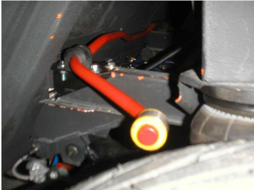
Atornillamos la fijación inferior, colocando el suplemento de 5mm en el tornillo delantero para compensar la depresión existente.
