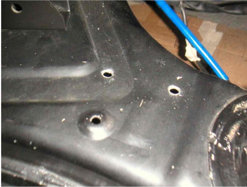
Après on mets les platines de fixation du chassis. On les mets dans son emplacement, on mets le vis supérieur, avec son entretoise. Il faut l'introduire dans le trou du chassis et le tourner 90° pour travailler comme écrou. On le bloque pour le serrer avec un tournevis, une fois placé le vis du bas.
