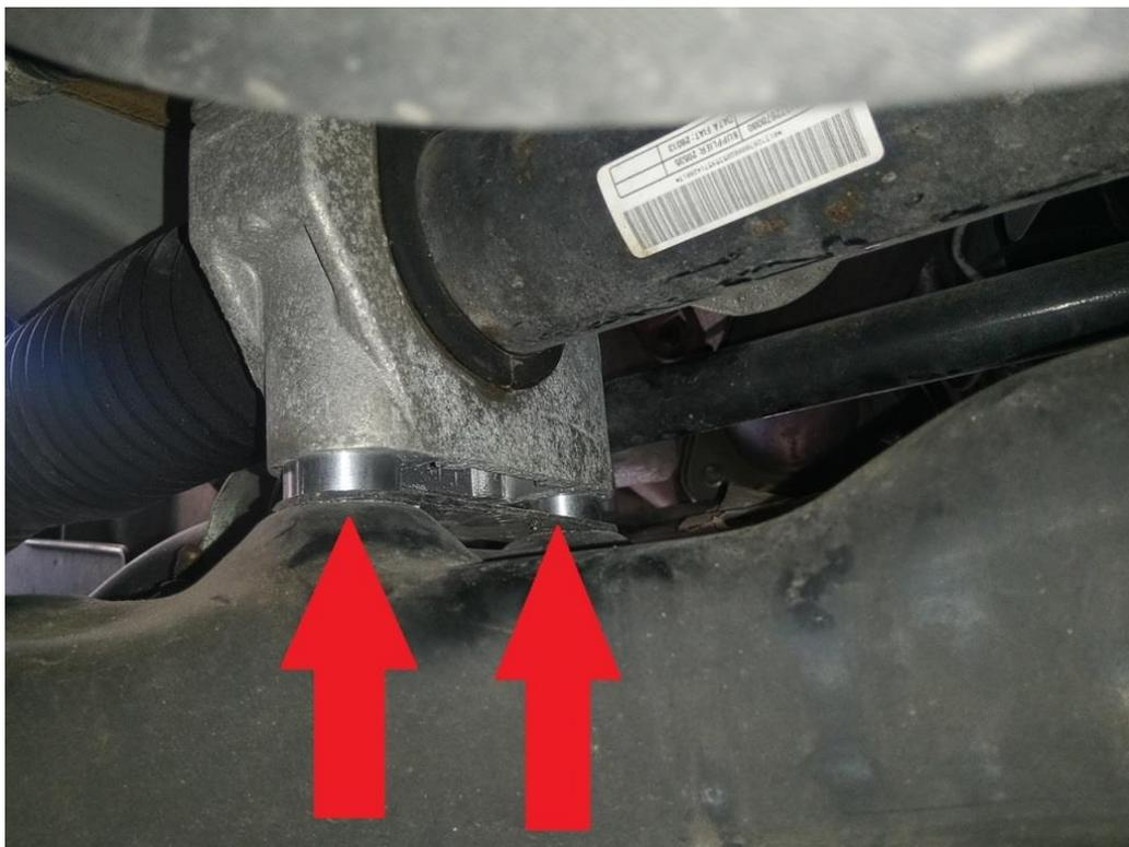
Hay que soltar los tornillos, colocar los casquillos y volver a atornillar con la tornillería incluida en el kit.
