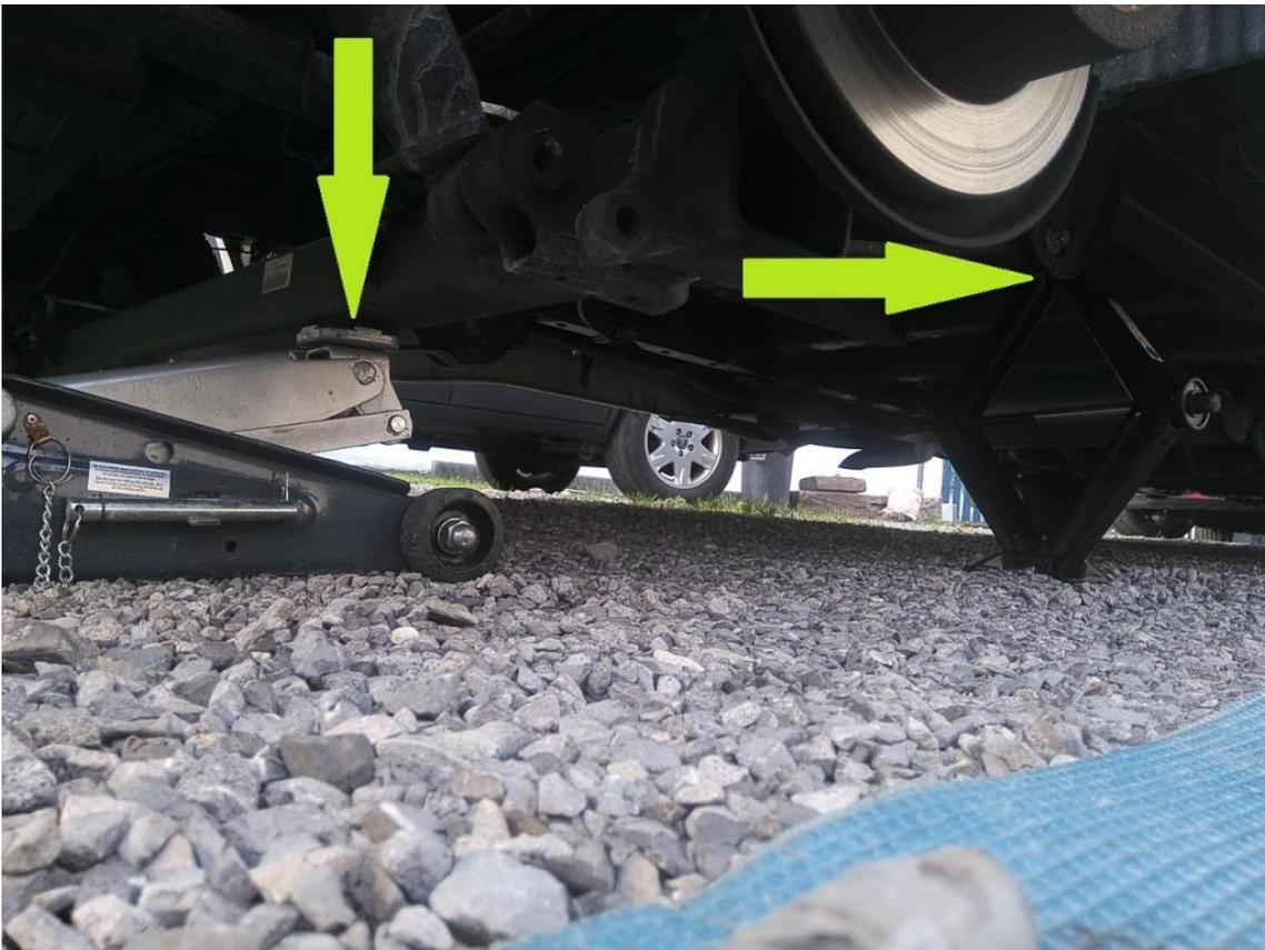
A continuación soltamos el amortiguador trasero (**flecha roja**) y podemos soltar la ballesta y bajar el eje para colocar el suplemento
