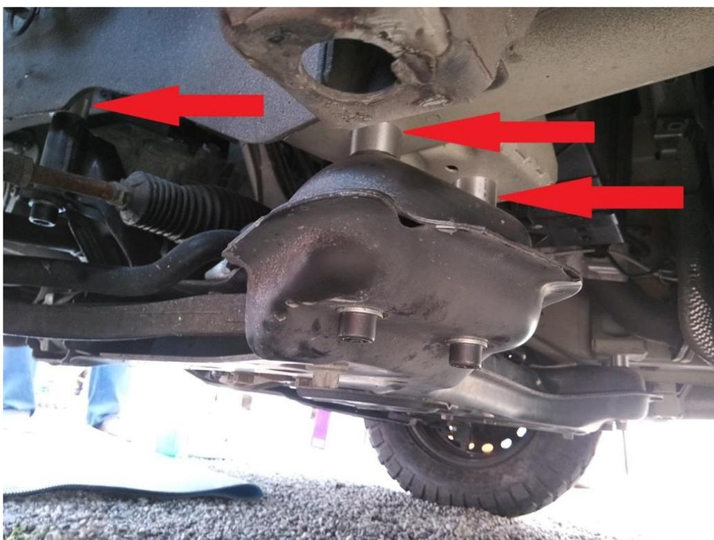
D'abord un côté, puis l'autre. Les douilles longues et les vis doivent être placées sur la crémaillère de direction assistée.
