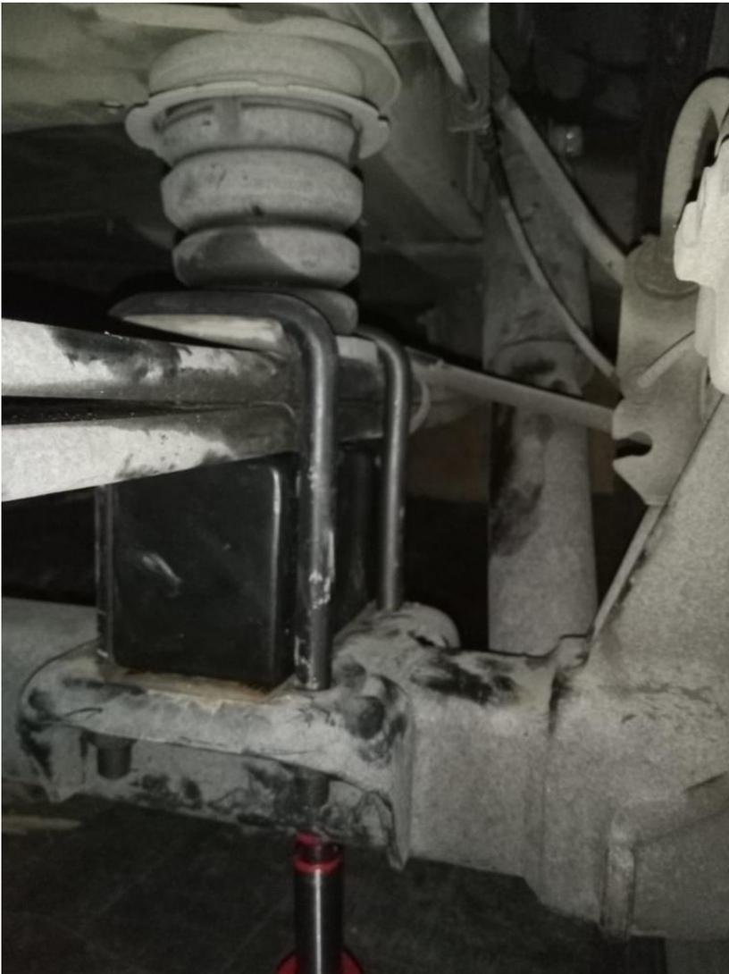
Il est conseillé de monter des amortisseurs plus longs, car les standards ne sont pas assez longs.
