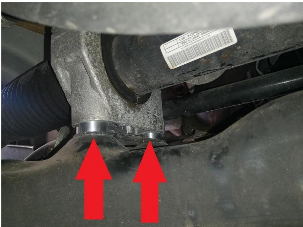
Il faut desserrer les vis, placer les bagues et les revisser avec les vis incluses dans le kit.
