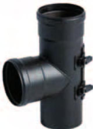
Ce Té dispose d'un accès facile afin de permettre le contrôle et le nettoyage des imbrûlés. La porte est fournie avec un joint silicone façonné afin de garantir l'étanchéité aux pressions et à la résistance thermique. Doté de charnières qui permettent de l'ouvrir soit d'un côté que de l'autre.
