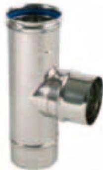
Elément permettant le raccordement au conduit de fumée avec un angle de 90°. La partie horizontale, disponible **femelle** ou **mâle**, n'étant pas soudée mais obtenue par extrusion, elle est autoportante et garantit une étanchéité parfaite.
