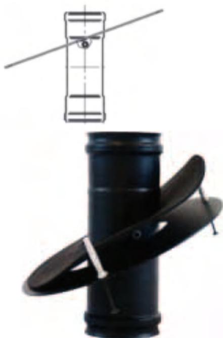
Cet article, comparé au précédent, présente la possibilité d'adapter la bride oscillante à une pente du toit de 0° à 45° grâce à l'application d'un anneau avec coupe elliptique. Fourni avec des chevilles pour la fixation et joint d'étanchéité d'épaisseur 3 mm.
