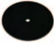
Le joint est toujours en addition de la trappe de visite. Il est réalisé en kevlar exempté d'amiante résistant à 320° de sollicitation continue. La substitution est conseillée chaque fin de saison d'hiver.
