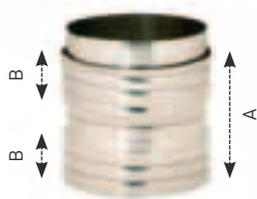
Le filetage du produit garantit une jonction avec le conduit ne pouvant pas se désunir et l'emboîture inférieure crée l'amorce pour la canalisation des condensats. Associé à l'utilisation de mastics silicone thermorésistants, il garantit une excellente tenue aux pressions. Le système qui en résulte est conforme aux caractéristiques prévues par les normes en vigueur.
