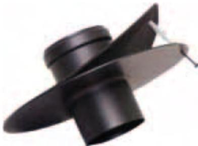
Élément permettant de relier un conduit de raccordement à un conduit de fumée préexistant, tant sur plafond que sur paroi. Grâce aux dimensions extérieures de la rosace, il couvre le diamètre du trou existant dans le mur jusqu'à un maximum de 200 mm, tout en garantissant au centre l'entrée femelle pour le conduit de raccordement. Fourni avec des chevilles diamètre 6 mm pour la fixation et joint d'étanchéité arrière de 3 mm d'épaisseur.
