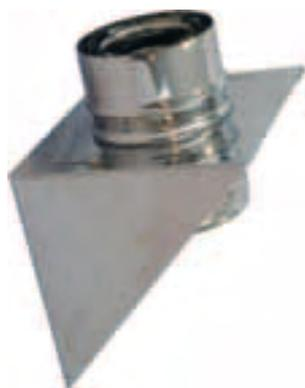
Cet article sert à supporter le poids du conduit de fumée. Les plaques de fixation sont fournies avec la visserie et il est conseillé de le placer au-dessous du té.
