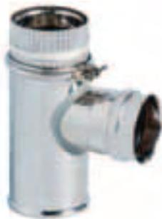
Le Té avec sortie horizontale simple paroi femelle diamètre 80 est utilisé pour la jonction du poêle à granulés au conduit de raccordement slim.
