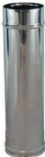
Élément pour la réalisation du conduit de raccordement, qui permet l'évacuation des produits de combustion via le conduit intérieur et l'amenée d'air comburant via l'espace annulaire réalisé entre les conduits intérieur et extérieur.
