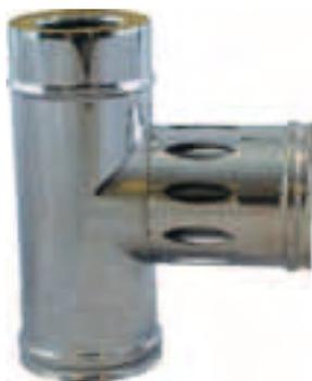
Té double paroi avec sortie horizontale coaxiale. Il est utilisé pour le passage du conduit de raccordement coaxial intérieur au conduit de fumées extérieur. Il garantit toujours le sens des fumées et de l'air séparés grâce aux "trous/fentes" sur la partie horizontale. Pour ce raccord il est nécessaire d'appliquer les rallonges prévues pour la bride murale, parce que la distance horizontale est majorée.
