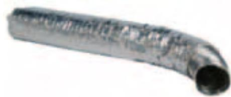
Coquille qui complète la gamme des tuyaux en aluminium pour canalisation d'air chaud, réalisée en laine de verre d'épaisseur 6 mm et densité 130kg/m<sup>3</sup>. Elle est revêtue d'aluminium tramé. Elle permet de maintenir la température transportée jusqu'à la fin du conduit.
