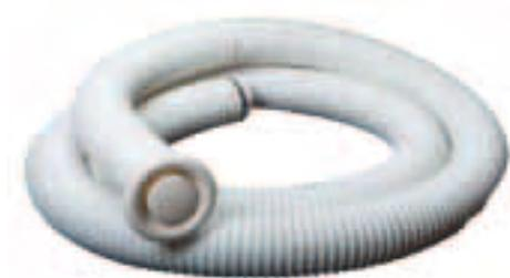
Ce tuyau est indiqué pour le transport d'air chaud produit par les poêles canalisables et sa particularité est de maintenir le diamètre nominal aussi bien avec un rayon de cambrure 90°, ceci est possible grâce à une lame d'acier qui soutient le tissu thermorésistant à 125°.
