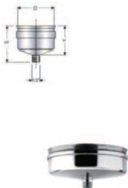
Il peut être appliqué comme pièce initiale du conduit de fumée lorsque ce dernier ne commence pas par la base de départ. Son but est de collecter les éventuels condensats ou les eaux pluviales. On peut appliquer un bouchon borgne à la sortie et vider ensuite manuellement de manière périodique ; en alternative on peut installer un tuyau permettant d'amener l'évacuation au sol ou dans la gouttière la plus proche.
