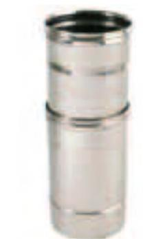
Élément permettant une extension de 120 mm le long d'un montage linéaire (h. min 320 mm – h max. 440 mm) Dans les portions verticales, il nécessite un support plancher car il n'est pas autoportant.
