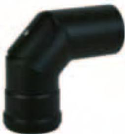
Raccord d'angle avec trappe de visite et joint d'étanchéité servant à changer la direction du conduit de raccordement de 90°. Il permet aussi la vérification et le nettoyage du conduit de raccordement.
