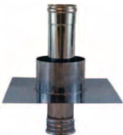
Cet article est positionné près qu'à la fin du conduit de fumée, permettant la jonction entre le tuyau flexible et le chapeau simple paroi, ce qui garantit la fermeture du conduit maçonné existant. La plaque est fournie avec « fentes » pour l'entrée d'air comburant, protégées par un cylindre métallique. A utiliser avec la collerette pour empêcher l'entrée d'eau.
