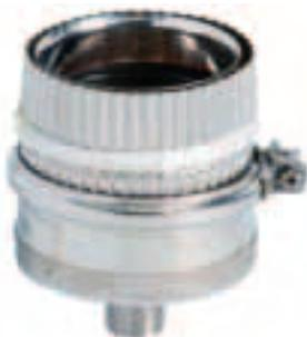
Il peut être appliqué comme pièce initiale du conduit de fumée lorsque ce dernier ne commence pas par la base de départ. Son but est de collecter les éventuels condensats ou les eaux pluviales. On peut appliquer un bouchon borgne à la sortie et vider ensuite manuellement de manière périodique ; en alternative on peut installer un tuyau permettant d'amener l'évacuation au sol.
