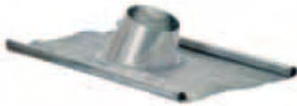
A la différence du précédent, le solin incliné relie le conduit de fumée à la couverture inclinée du bâtiment. Sa forme en permet l'application sur des toits avec des pentes jusqu'à 30° et garantit l'imperméabilité absolue aux eaux pluviales.
