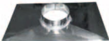
Réalisée en acier inox avec anneau soudé pour soutenir le tuyau avec le support flexible (voir l'article suivant), elle représente la finition optimale pour la gaine flexible intubé. Sa conception empêche la rechute des matériaux à l'intérieur de la gaine et permet l'écoulement des eaux pluviales.
