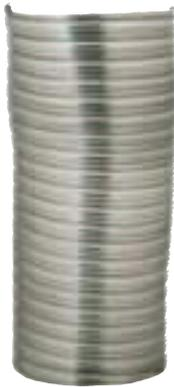
Le flexible est produit en acier AISI 316 épaisseur 10/10 pour les deux parties. Il est utilisé pour le tubage et la rénovation d'anciennes cheminées. Pouvant être facilement courbé sans entraîner de modifications du diamètre intérieur, il permet de réaliser des installations en toute simplicité.
