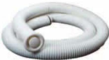
Ce tuyau est indiqué pour le transport d'air chaud produit par les poêles canalises et sa particularité est de maintenir le diamètre nominal aussi bien avec un rayon de cambrure 90°, ceci est possible grâce à une lame d'acier qui soutient le tissu thermorésistant à 125°.
