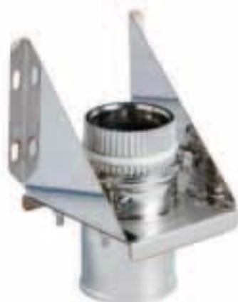
Cet article va a soutenir le poids du conduit de fumée. Les plaques de fixation sont fournies avec visserie et il est conseillé de le positionner au-dessous du Té.
