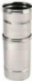
Élément permettant une extension de 120 mm le long d'un montage linéaire (h. min 320 mm – h max. 440 mm) Dans les portions verticales, il nécessite un support plancher car il n'est pas autoportant.
