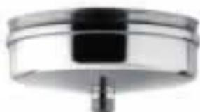
Il peut être appliqué comme pièce initiale du conduit de fumée lorsque ce dernier ne commence pas par la base de départ. Son but est de collecter les éventuels condensats ou les eaux pluviales. On peut appliquer un bouchon borgne à la sortie et vider ensuite manuellement de manière périodique ; en alternative on peut installer un tuyau permettant d'amener l'évacuation au sol ou dans la gouttière la plus proche.
