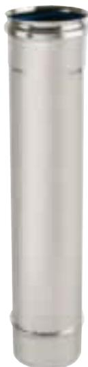
Les éléments droits sont produits dans les différentes longueurs dont on doit soustraire la hauteur de l'emboîture, soit 50 mm. L'étanchéité est garantie par le joint en silicone (de série jusqu' au diam. 160), la tenue mécanique étant assurée par le collier d'assemblage.
