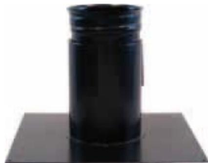
Ce raccord, à la différence du précédent, permet de relier le conduit de raccordement vertical à un conduit maçonné existant à raccorder avec le tuyau flexible du même diamètre. Réalisé en acier épaisseur 08/10 avec interstice et bride mesures 400 x 400.
