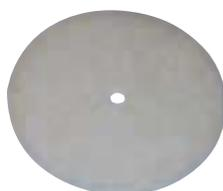
Le joint en tissu de fibres céramiques est toujours fourni avec la trappe de visite. Il est réalisé en 2 mm d'épaisseur, et résiste à des températures continues de 650°C et à l'humidité. Le remplacement est conseillé chaque fin de saison d'hiver.
