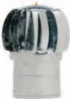
Cet élément facilite la sortie des fumées grâce au mouvement rotatif, garanti par le mécanisme installé sur des roulements à billes en bain d'huile. A utiliser avec chaudières, mais moins conseillé sur les conduits de cheminée pour poêles à bois. La suie qui se forme pendant la combustion de bois, pourrait se déposer dans le mécanisme, en bloquant le fonctionnement.
