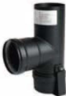
Élément avec un angle à 90° et tampon pour la récupération des condensats et/ou des imbrûlés. Cet élément est toujours conseillé comme départ pour l'évacuation des fumées arrière d'un poêle à granulés. Il est recommandé de remplacer les joints à la fin de chaque hiver, pour favoriser le remplacement 2 joints sont inclus dans l'emballage. Disponible aussi la version avec sortie supérieure femelle (**code avec suffixe FF**) et la version diamètre 100 avec sortie horizontal diamètre 80.
