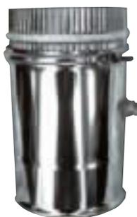
Cet élément permet le prélèvement et l'analyse des fumées comme prescrit par le DPR italien 1391 art. 6.5 et 7.9 et par les normes UNI 13384. Sur les portions verticales, il est positionné sur le Té où il est prévu par la réglementation. La pièce est de hauteur 250 mm et le trou pour insérer la sonde est de 8 mm.
