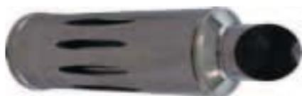
Le terminal concentrique horizontal est utilisé pour réaliser l'évacuation des fumées et la prise d'air comburant. Il doit être installé seulement avec débouche en zone 3, la distance entre sol et terminal à paroi doit être 2 mètres et il doit dépasser le mur périmétral de 40 cm ( voir Figure 7 du DTA).
