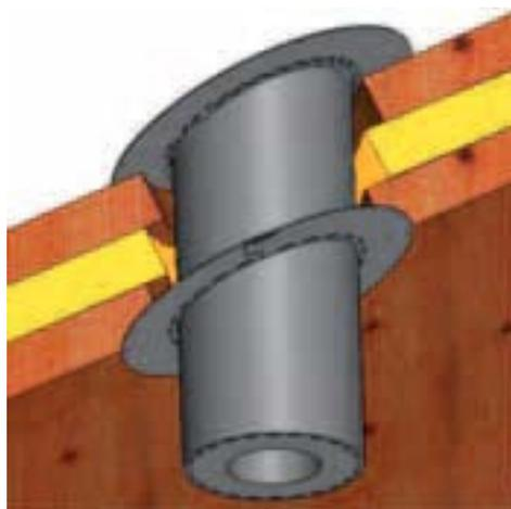
L'intérieur du raccordement prévoit un passage télescopique dans lequel peut coulisser le tuyau du diamètre prévu par le générateur de chaleur jusqu'à 200 mm.
