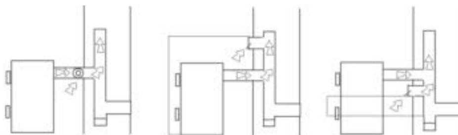
Exemple du montage du régulateur de tirage sur un conduit de fumée simple paroi inox en intubation, possible aussi sur conduit de fumée double paroi isolé et conduit de raccordement.
