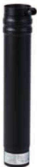
Le tuyau télescopique a été construit pour réaliser des installations de poêles à granulés de manière rapide, en respectant les normes en vigueur. Avec ce produit il ne serait plus nécessaire de mesurer préalablement le conduit de raccordement parce qu'on peut couvrir les distances plus ou moins longues avec les 2 mesures du tuyau télescopique, 1000 ou 500 mm. Il ne sera plus nécessaire d'utiliser outils de coupe et couleur pour retouches.
