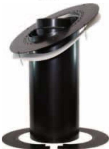
L'intérieur du raccordement prévoit un passage télescopique dans lequel peut coulisser le tuyau du **diamètre prévu par le générateur de chaleur jusqu'à 200 mm**. Le passage télescopique est espacé de la partie extérieure par un interstice de 50 mm, qui contient une laine de fibres réfractaires résistante jusqu'à 1100°C, et d'un espace d'air libre de 15 mm dû à la présence de « fentes » sur la rosace de finition.
