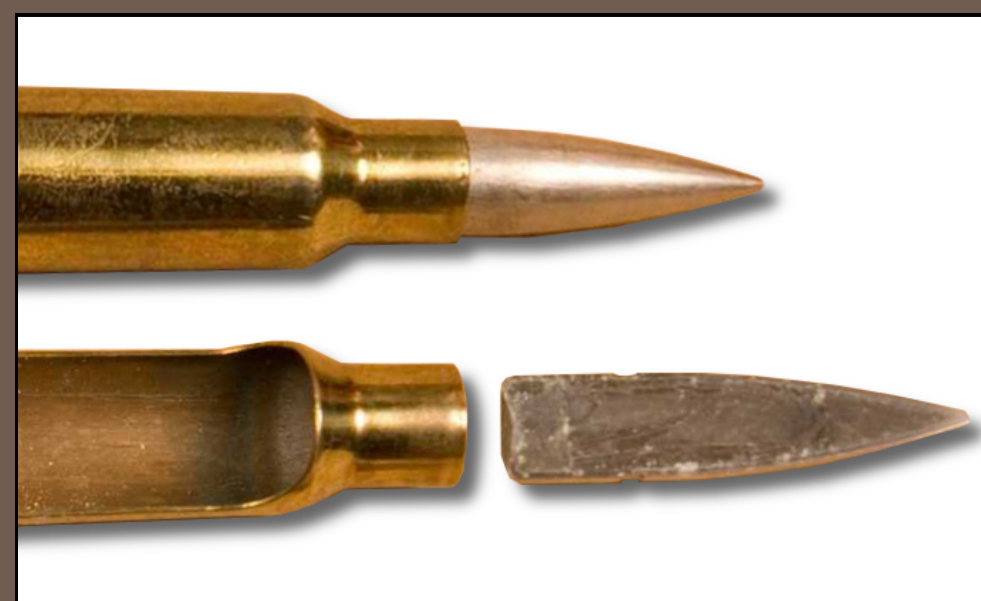
Nabój 7,92 x 107 mm DS - podstawowa amunicja karabinu przeciwpancernego wz. 35 "UR".
