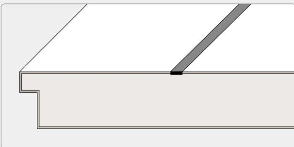
Der in verschiedenen Oberflächen erhältliche Lines PLAN-Keder wird in das Türblatt eingelegt.
