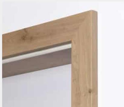
Vorhandene Stahlzargen lassen sich normalerweise nicht ohne Weiteres bzw. nicht ohne größere Stemmarbeiten ausbauen. Dabei kann es passieren, dass der Boden mit aufgestemmt werden muss. Die ASTRA Ummantelungszargen sind so ausgeführt, dass sie einfach auf die Stahlzarge aufgesteckt werden und diese komplett überdecken. So wird ein sauberes Zargenbild erzielt, ohne die vorhandene Substanz zu beschädigen.
