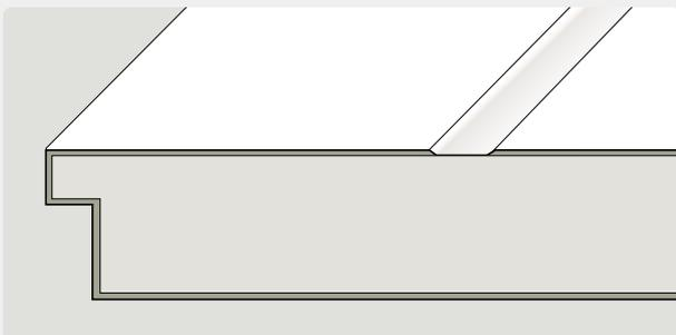
Fräsung breit, Kanten abgeschrägt
