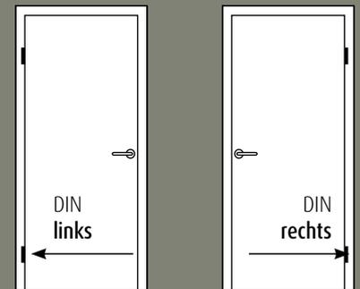
Die DIN Richtung gibt an, in welche Richtung die Tür geöffnet wird. Sie wird von der Türseite aus ermittelt, an welcher sich die Bänder befinden.
