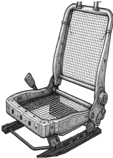
באיור זה הגב והמושב עשויים רשת סינתטית והשלדה מתכת. לרוב, במושב ובגב משולבים גם קפיצי זיג-זג ממתכת
