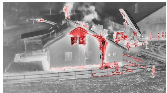
Bild 4: Sichtbarkeit von Brandverlauf und Glutnestern mittels Drohnenbildern.
