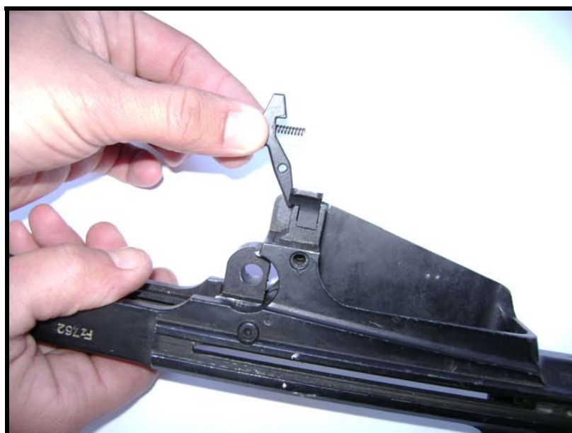
Fig 3.62 - Retirada do retém do carregador
