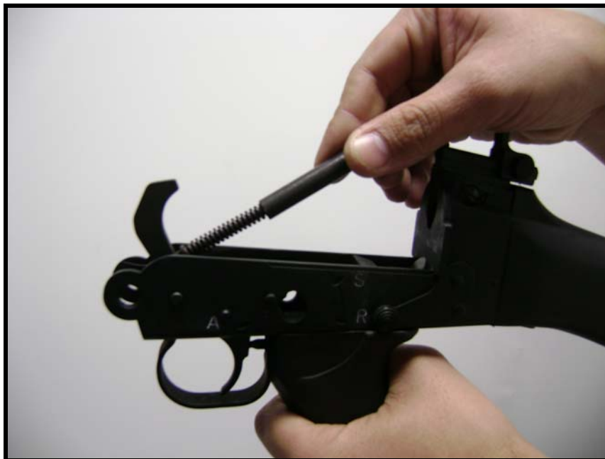
Fig 3.76 - Retirada do conjunto Haste-guia-mola do martelo
