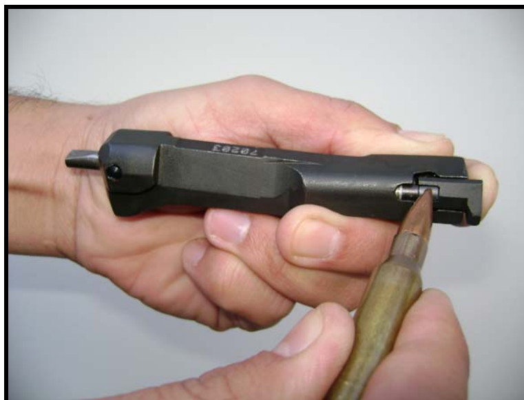
Fig 3.27 - Desmontagem do extrator com o auxílio da ponta de um cartucho
