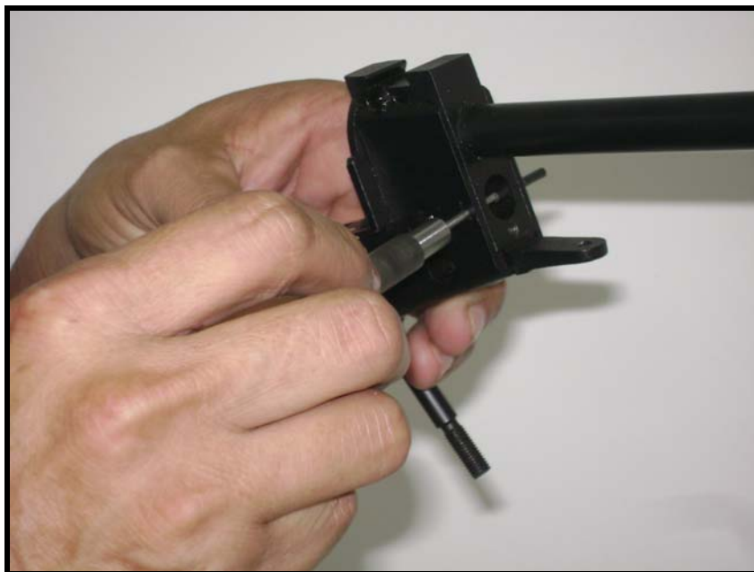
Fig 3.105 - Retirada do pino-guia do trinco da armação com o auxílio de um toca-pino
