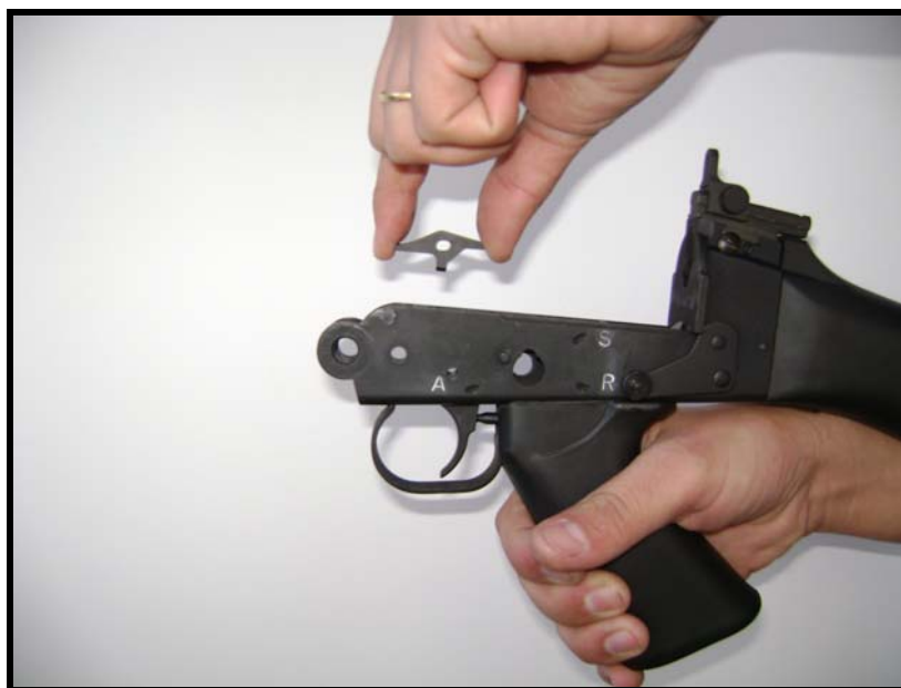
Fig 3.84 - Retirada do gatilho intermediário
