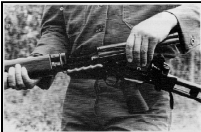
Fig 7.5 - Retirada do conjunto tampa-impulsor do ferrolho
