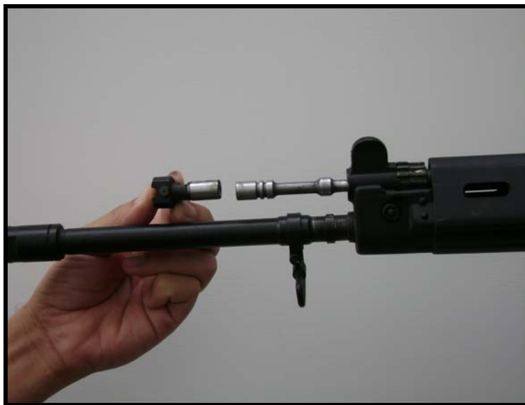
Fig 3.23 - Retirada do obturador do cilindro de gases
