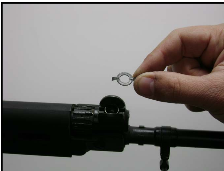
Fig 3.43 - Retirada do engrazador e da mola da massa de mira do seu alojamento
