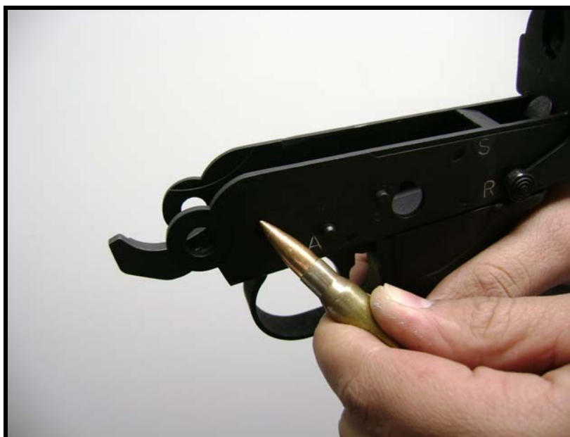
Fig 3.80 - Modo de empurrar o eixo do martelo, com auxílio de um cartucho
