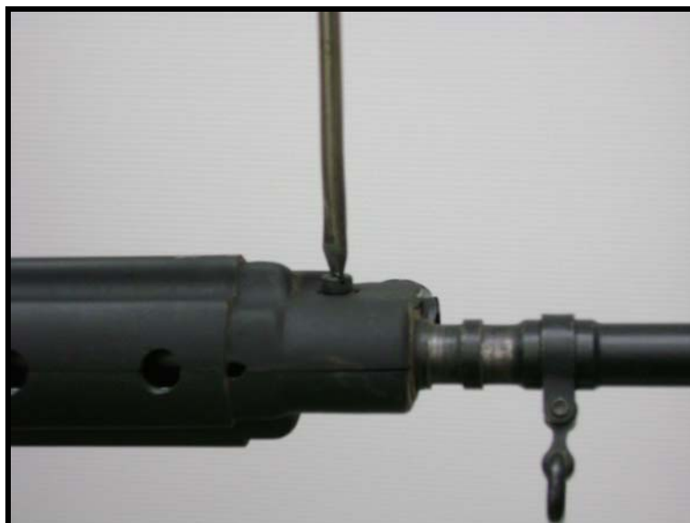
Fig 3.29 - Desmontagem do guarda-mão
