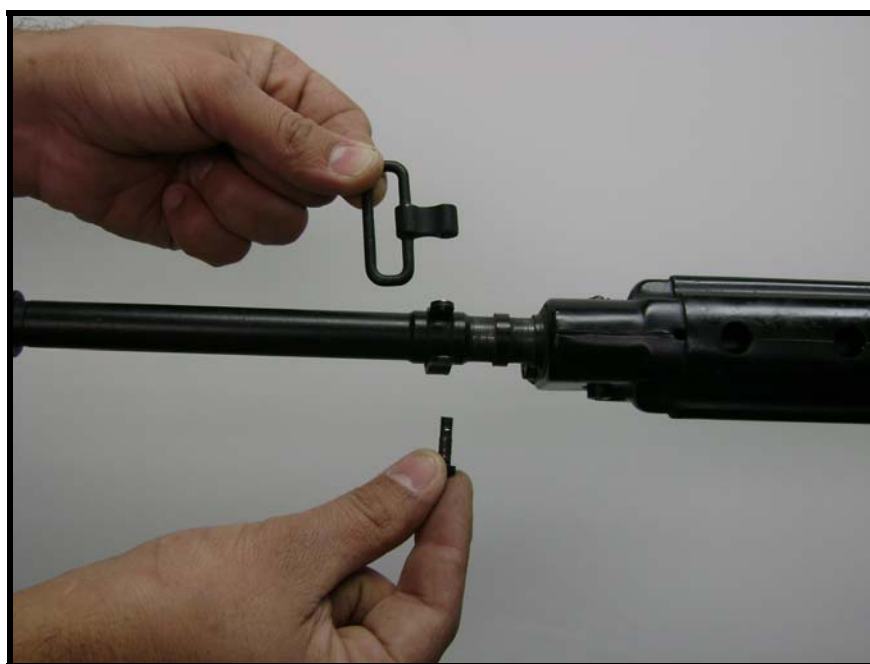
Fig 3.45 - Separação do zarelho da sua braçadeira
