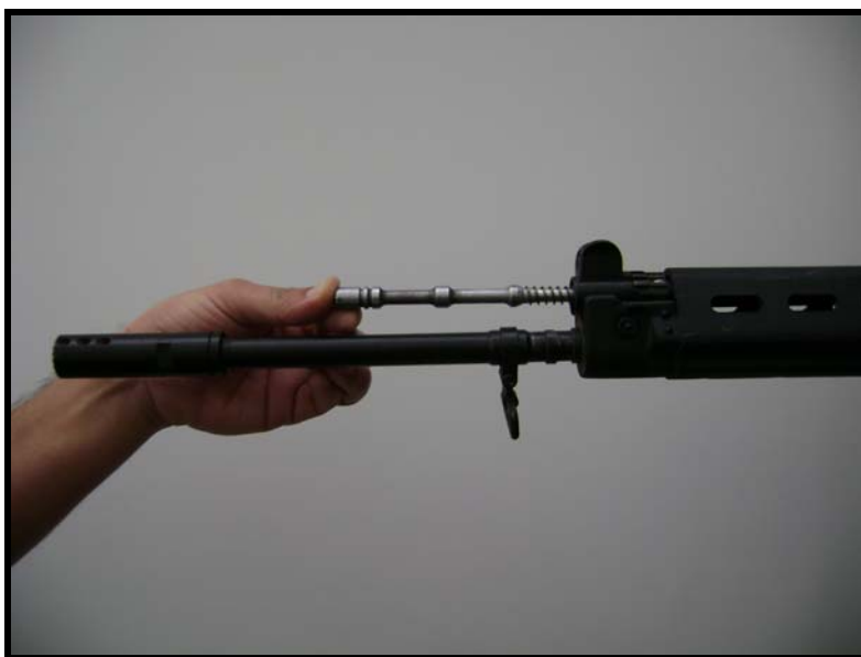
Fig 3.24 - Retirada do êmbolo do cilindro de gases
