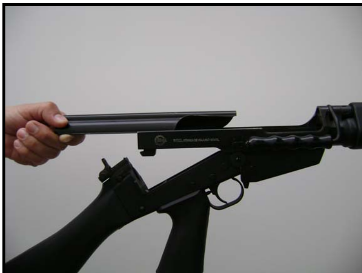
Fig 3.20 - Retirada da tampa da caixa da culatra
