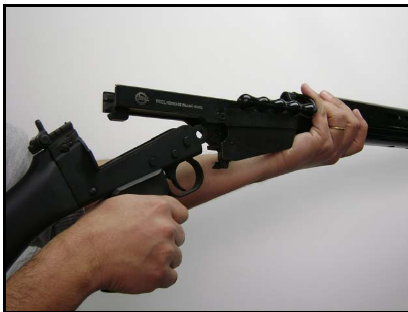
Fig 3.49 - Separação do conjunto cano-caixa da culatra do conjunto armação-coronha
