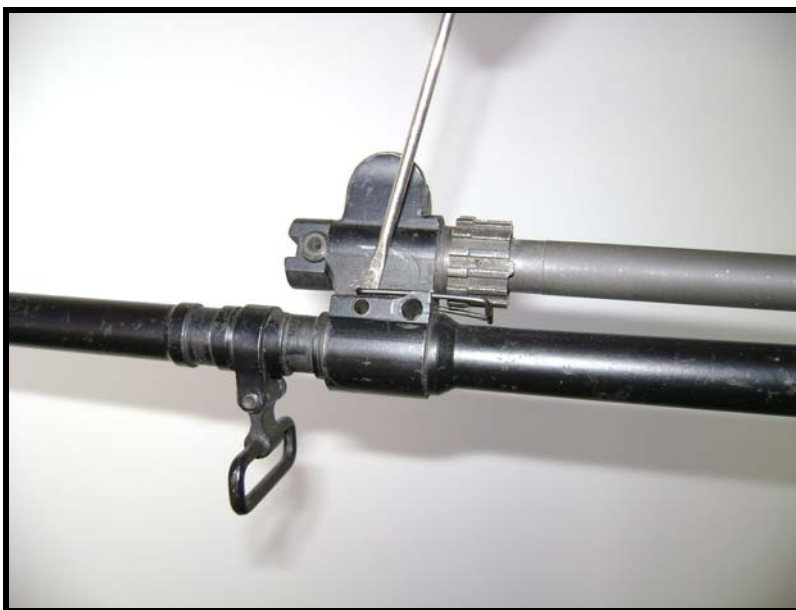
Fig 3.117 - Reposição da mola de travamento do anel regulador do escape de gases
