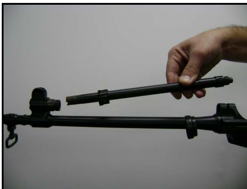
Fig 3.37 - Modo de retirar o cilindro de gases
