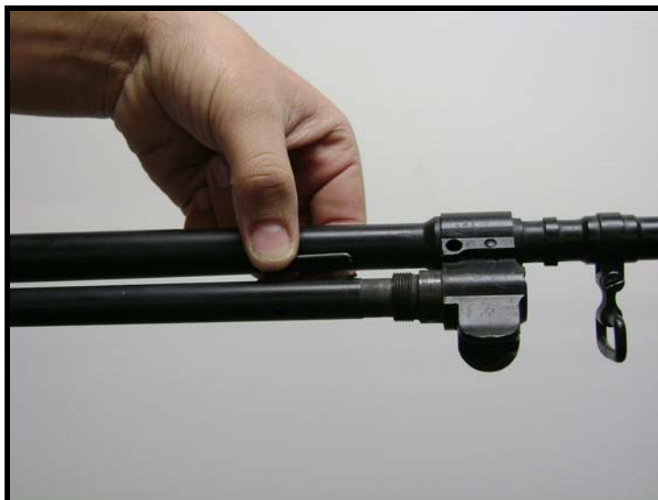
Fig 3.34 - Retirada da mola
