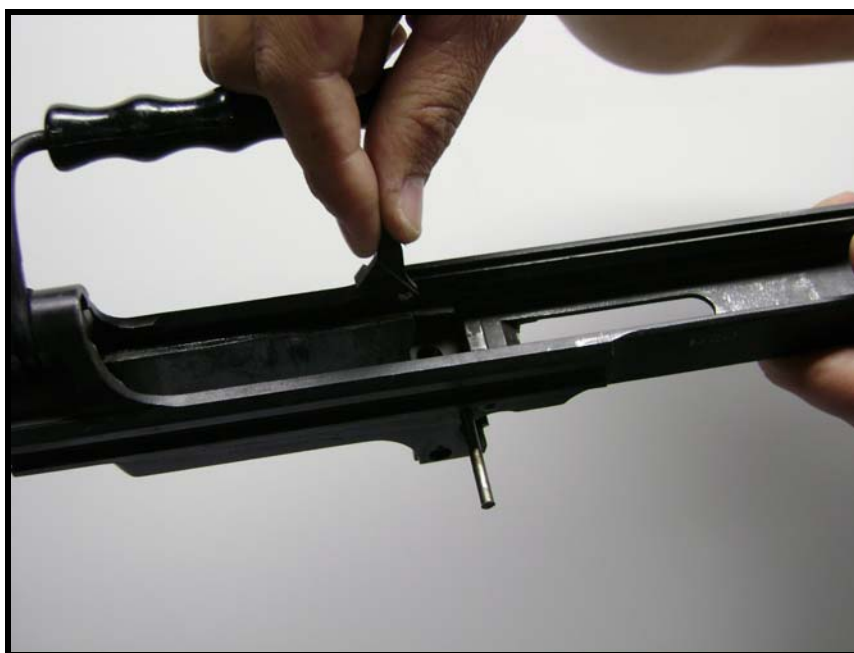
Fig 3.66 - Retirada do ejedor
