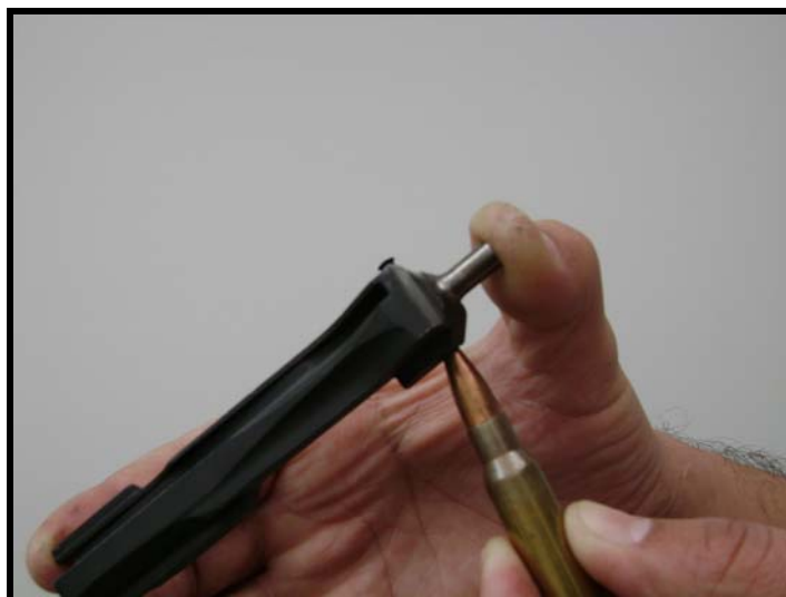
Fig 3.18 - Pressão na cauda do percussor e retirada do pino do percussor
