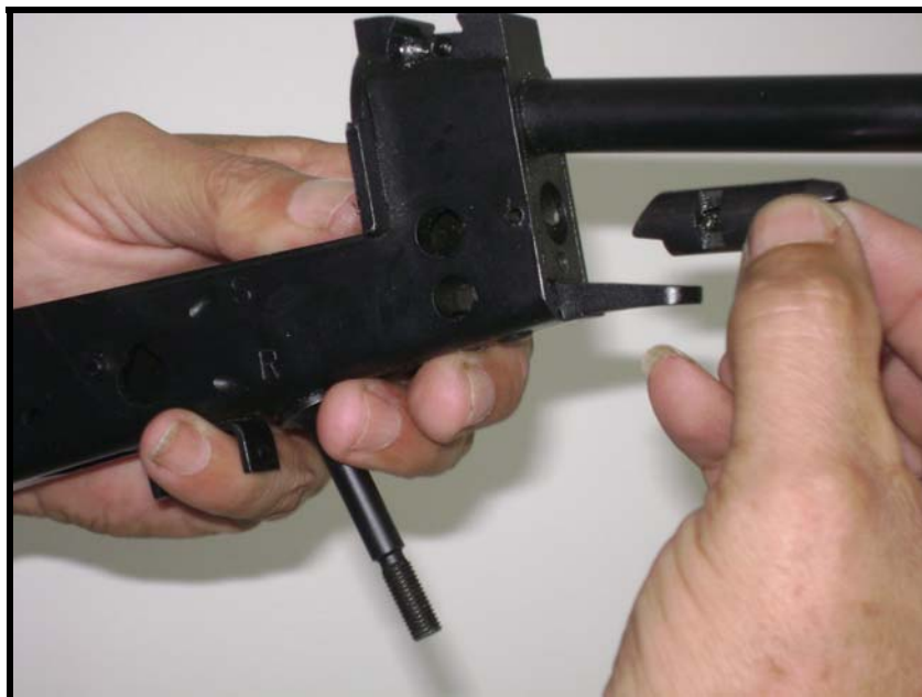
Fig 3.107 - Retirada do trinco da armação do seu alojamento
