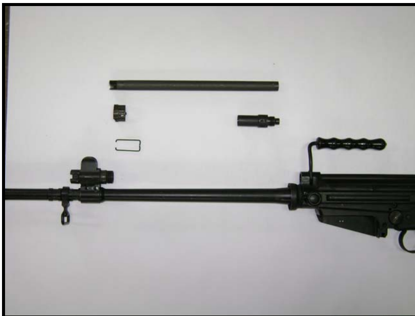
Fig 3.38 - Cilindro de gases, anel regulador e a luva do cilindro, separados Da alça de transporte
