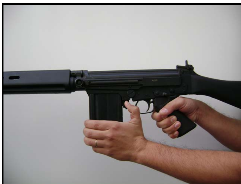
Fig 3.2 - Modo de abaixar o retém do ferrolho, para permitir o ferrolho ir à frente, quando o carregador está vazio.
