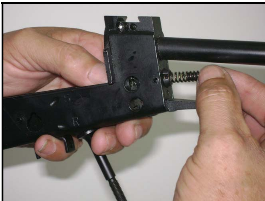
Fig 3.106 - Retirada da mola e do mergulhador do trinco da armação
