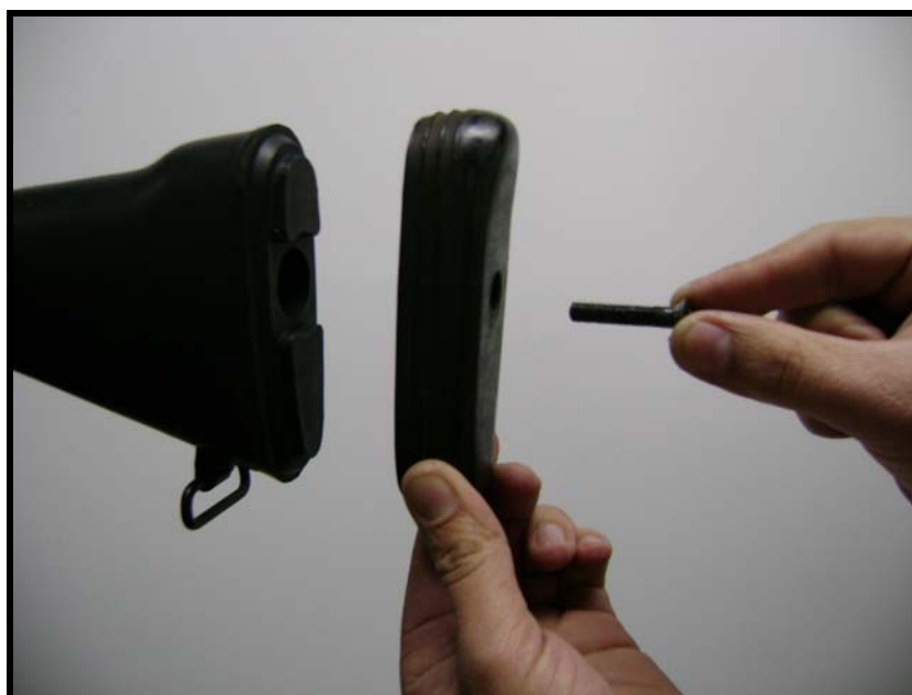
Fig 3.98 - Separação da chapa da soleira e do parafuso
