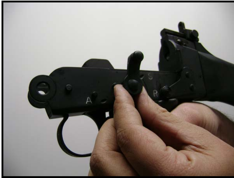
Fig 3.70 - Colocação na posição vertical do registro de tiro e de segurança, a fim de possibilitar sua retirada.
