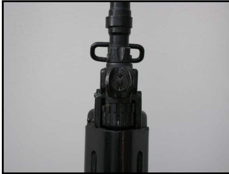
Fig 3.4 - Anel regulador em sua posição mais avançada
