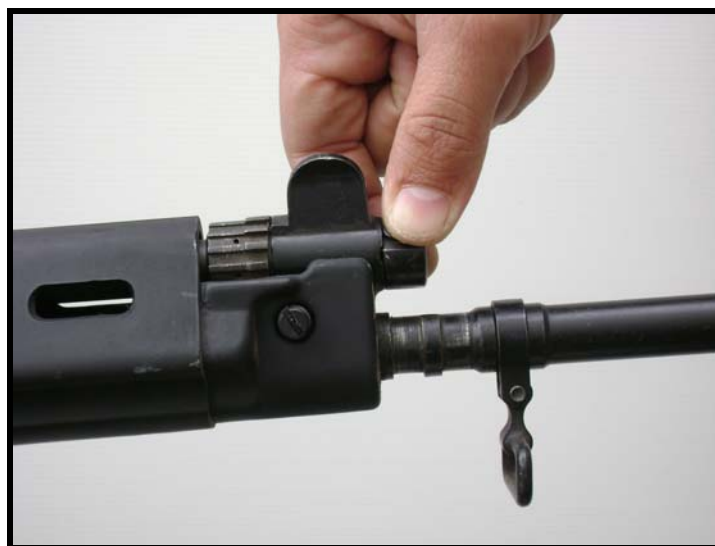
Fig 3.21 - Pressão sobre o retém do obturador do cilindro de gases.
