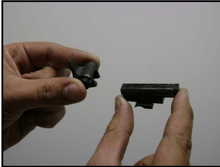
Fig 3.95 - Retirada do cursor da alça de mira
