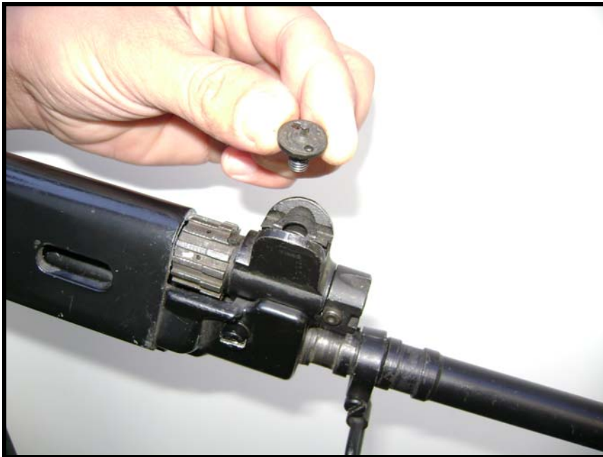
Fig 3.42 - Retirada da massa de mira
