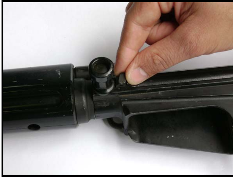
Fig 3.53 - Retirada da chaveta da alavanca de manejo
