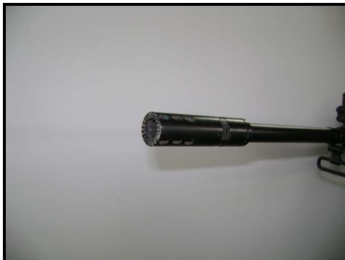
Fig 3.11 - Quebra-chamas para lançamento de granadas
