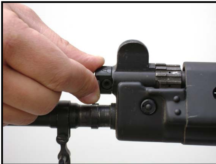
Fig 3.22 - Giro do obturador do cilindro de gases
