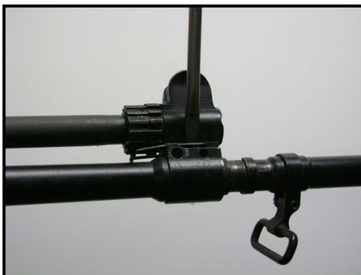
Fig 3.33 - Retirada das extremidades da mola de seus alojamentos no bloco do cilindro de gases
