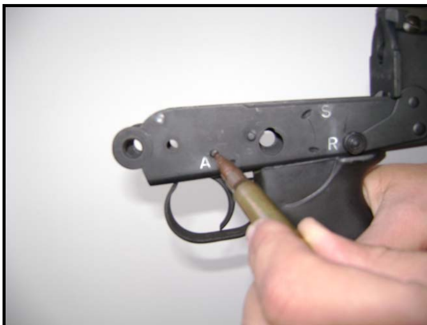
Fig 3.82 - Modo de impelir o eixo do gatilho intermediário com o auxílio de um cartucho
