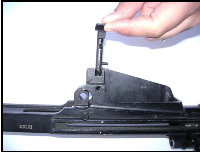
Fig 3.63 - Retirada do retém do ferrolho do seu alojamento
