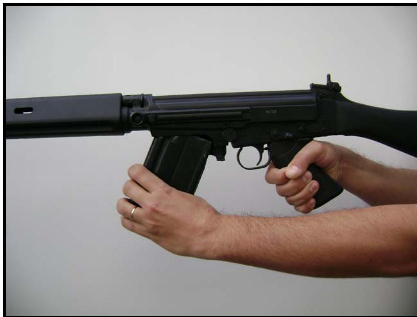
Fig 3.1 - Alimentação: Colocação do carregador no receptor do carregador
