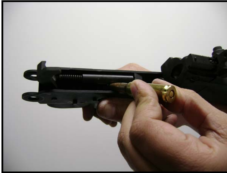
Fig 3.74 - Retirada do estojo da mola de seu alojamento na armação com o auxílio de um cartucho
