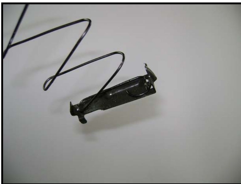
Fig 3.112 - Modo de repor a mola do transportador
