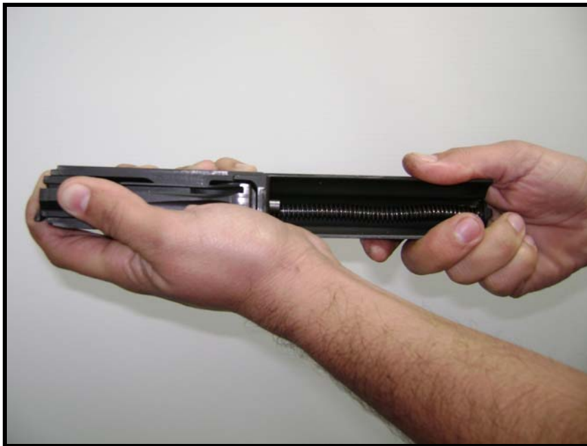
Fig 7.6 - Separação do impulsor do ferrolho da tampa
