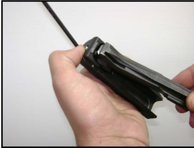
Fig 3.118 - Montagem do conjunto ferrolho-impulsor do ferrolho
