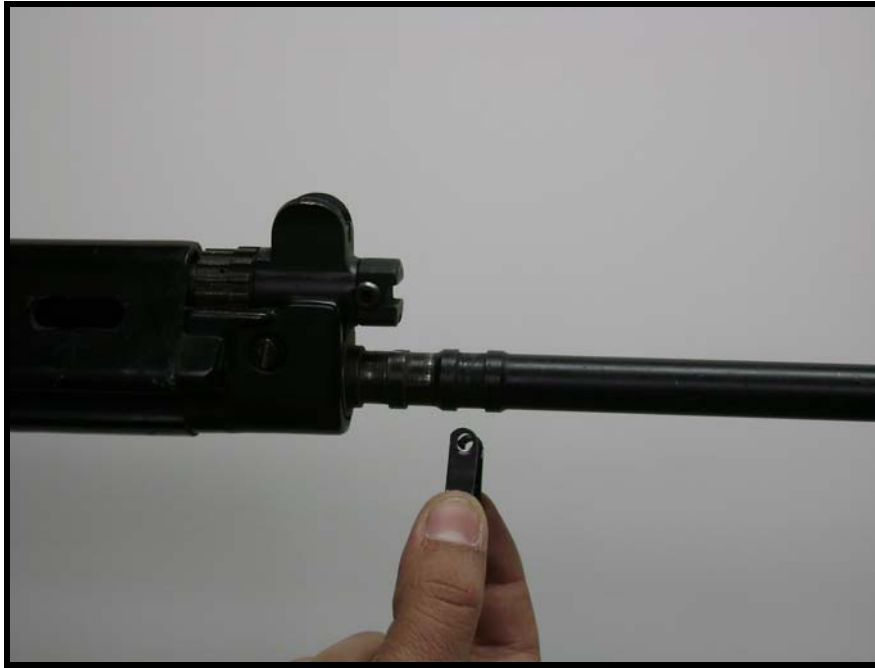
Fig 3.46 - Separação da braçadeira do cano
