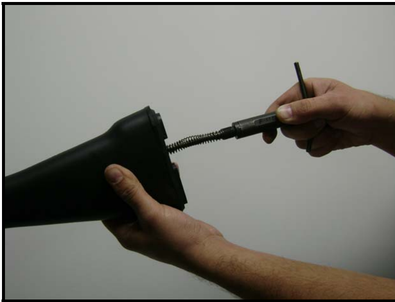
Fig 3.99 - Retirada do parafuso das molas recuperadoras com o auxílio de ferramenta especial e, a seguir, as molas
