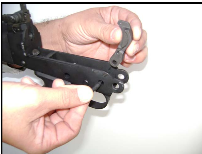
Fig 3.81 - Retirada do eixo do martelo e do martelo
