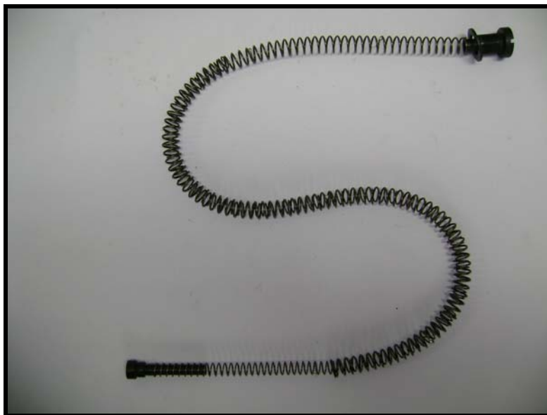
Fig 3.100 - Separação do parafuso, arruela, as duas molas (interior e exterior) e a haste das molas
