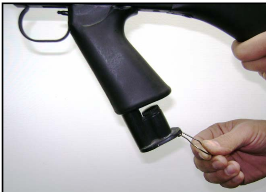
Fig 3.87 - Retirada do acessório de limpeza do punho
