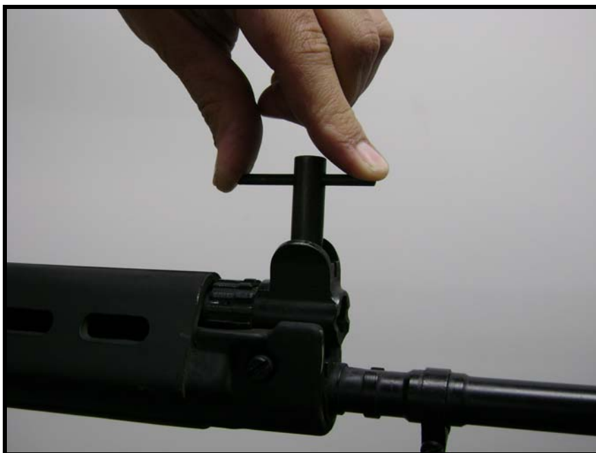
Fig 3.41 - Uso da chave da massa de mira para desparafusar a massa de mira
