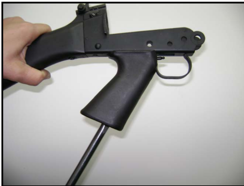
Fig 3.88 - Modo de desparafusar a porca de fixação do punho
