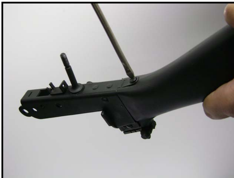
Fig 3.101 - Retirada do parafuso da coronha que liga a armação
