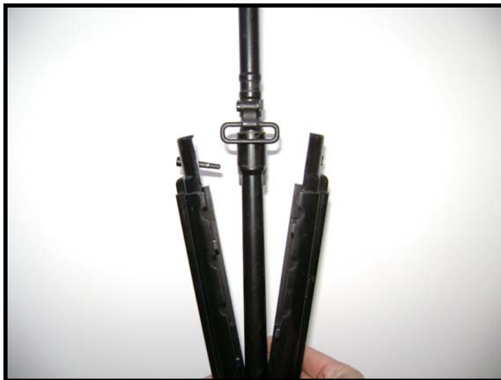
Fig 3.31 - Separação das placas do guarda-mão
