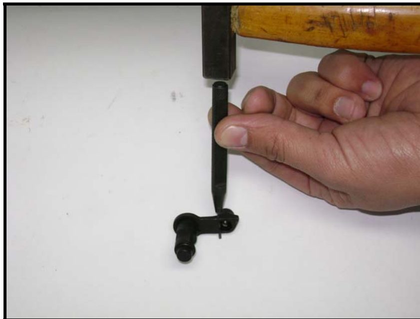
Fig 3.71 - Modo de retirar o pino do registro de tiro e de segurança, com o auxílio de um toça-pinos
