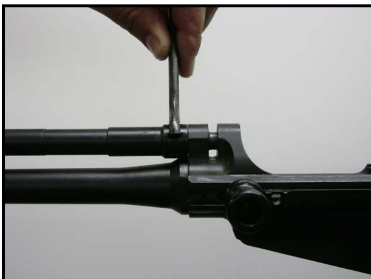
Fig 3.35 - Uso de chave especial para desparafusar a luva do cilindro de gases
