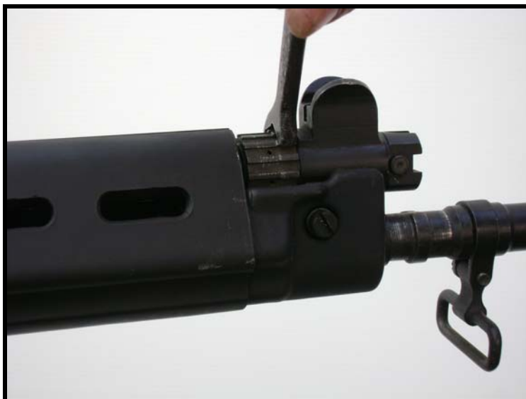
Fig 3.6 - Uso da chave para girar o anel regulador
