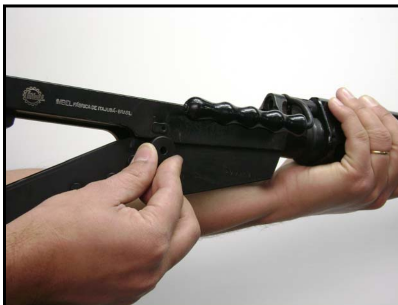
Fig 3.47 - Retirada do eixo da armação
