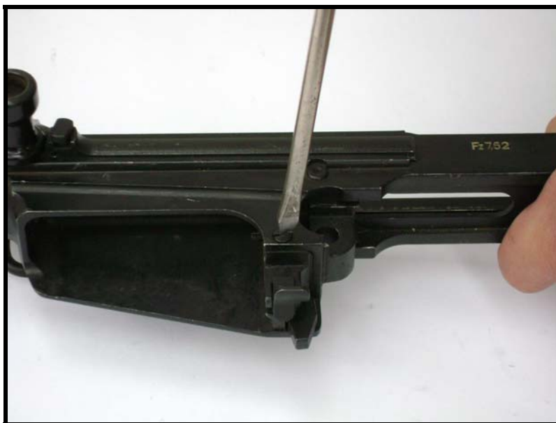
Fig 3.59 - Modo de desapertar o parafuso-eixo do retém do carregador
