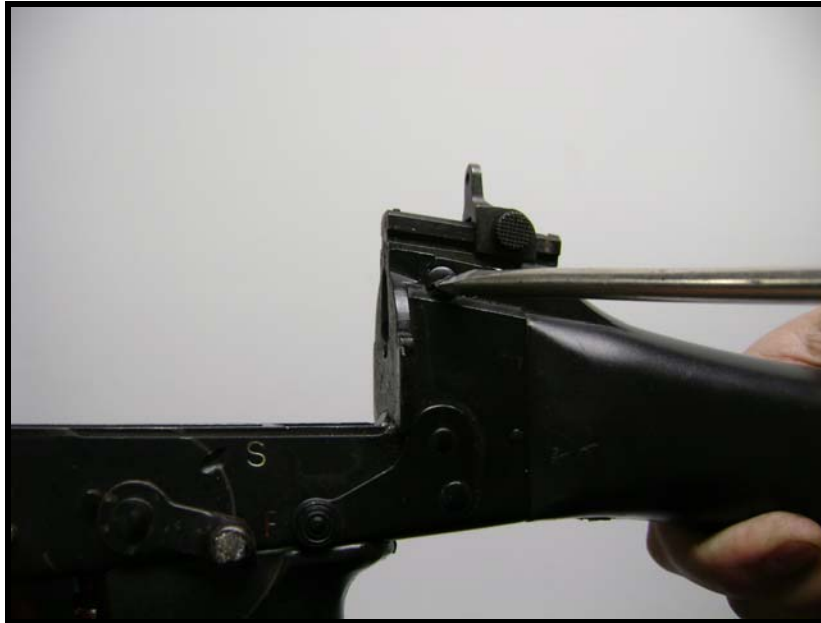
Fig 3.93 - Retirada de um dos parafusos de correção do desvio da alça de mira
