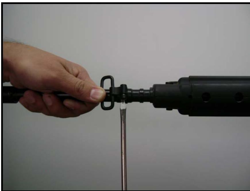
Fig 3.44 - Retirada do parafuso do zarelho anterior da bandoleira
