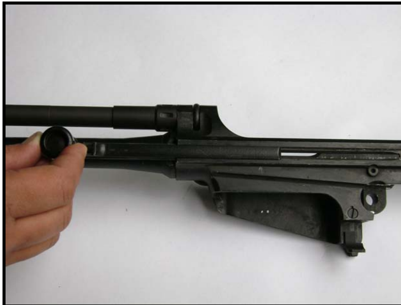
Fig 3.56 - Retirada da alavanca de manejo pela frente
