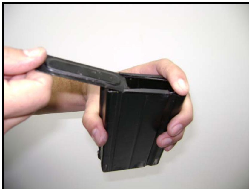
Fig 3.109 - Modo de puxar o fundo do carregador
