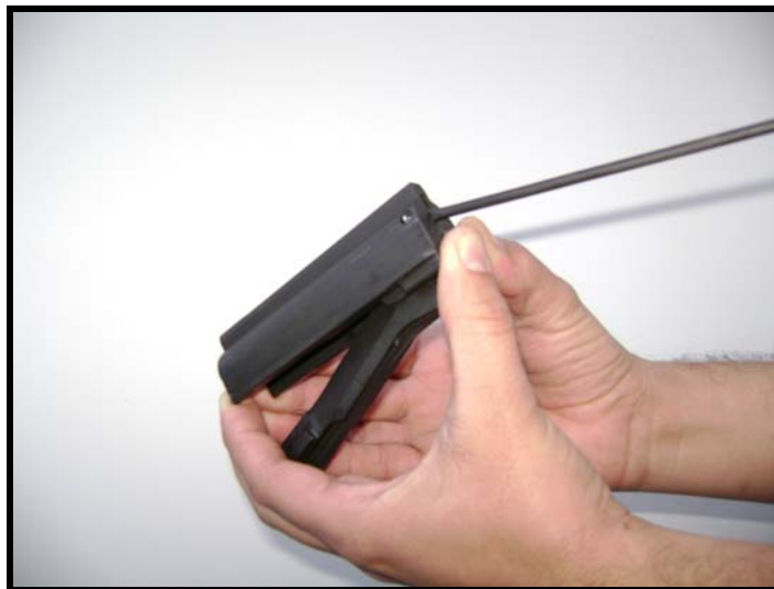
Fig 3.17 - Desmontagem do conjunto ferrolho-impulsor do ferrolho
