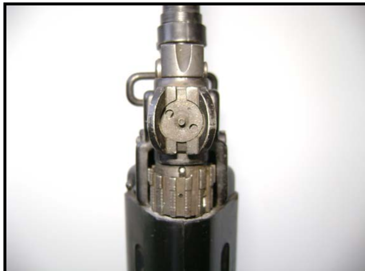
Fig 3.5 - Anel regulador na sua posição de abertura máxima para o escape de gases.
