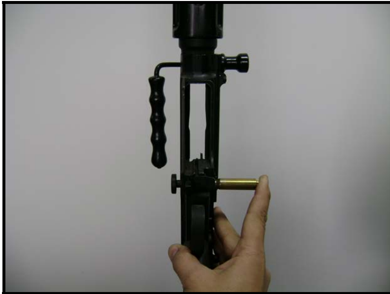
Fig 3.48 - Modo de retirada do eixo da armação de seu alojamento com o auxílio de um cartucho
