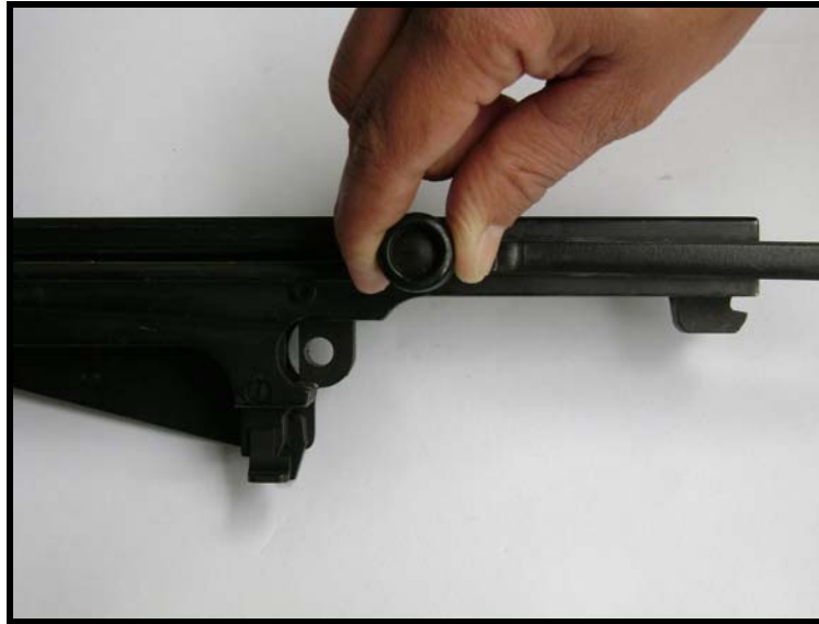
Fig 3.55 - Retirada da alavanca de manejo por trás
