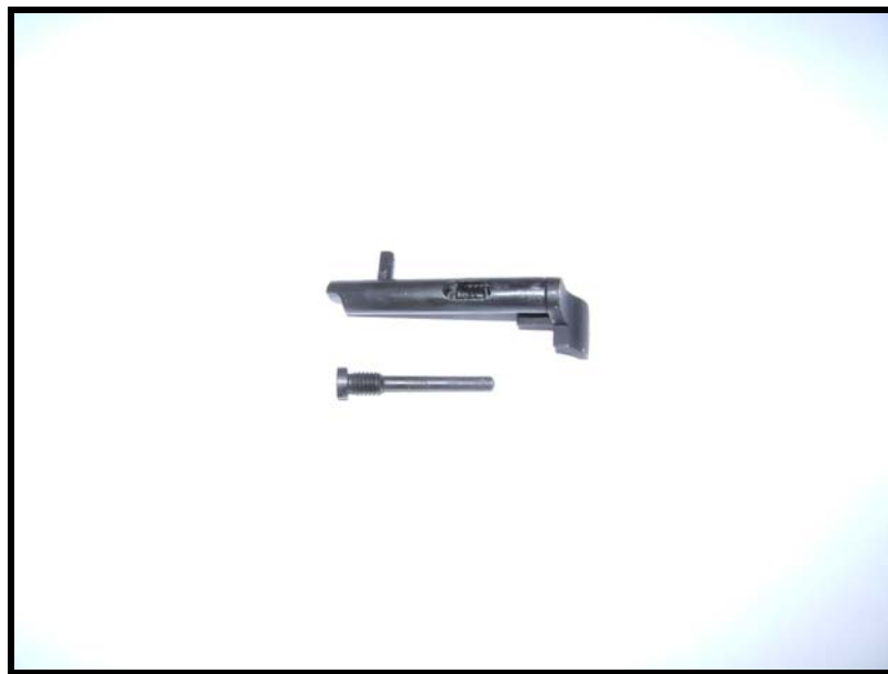
Fig 3.64 - Retém do ferrolho: corpo, pino da tecla, apoio da mola e a tecla
