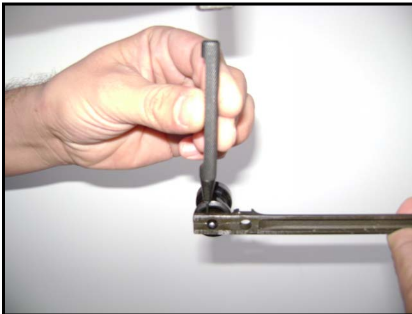
Fig 3.57 - Modo de retirar o pino do mergulhador do punho da alavanca de manejo, com o auxílio de um toca-pino
