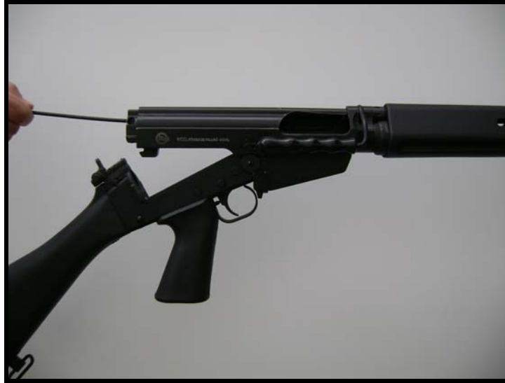
Fig 3.16 - Retirada do conjunto ferrolho-impulsor do ferrolho
