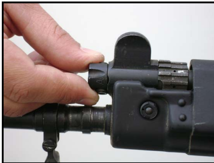
Fig 3.14 - Giro no Obturador do cilindro de gases
