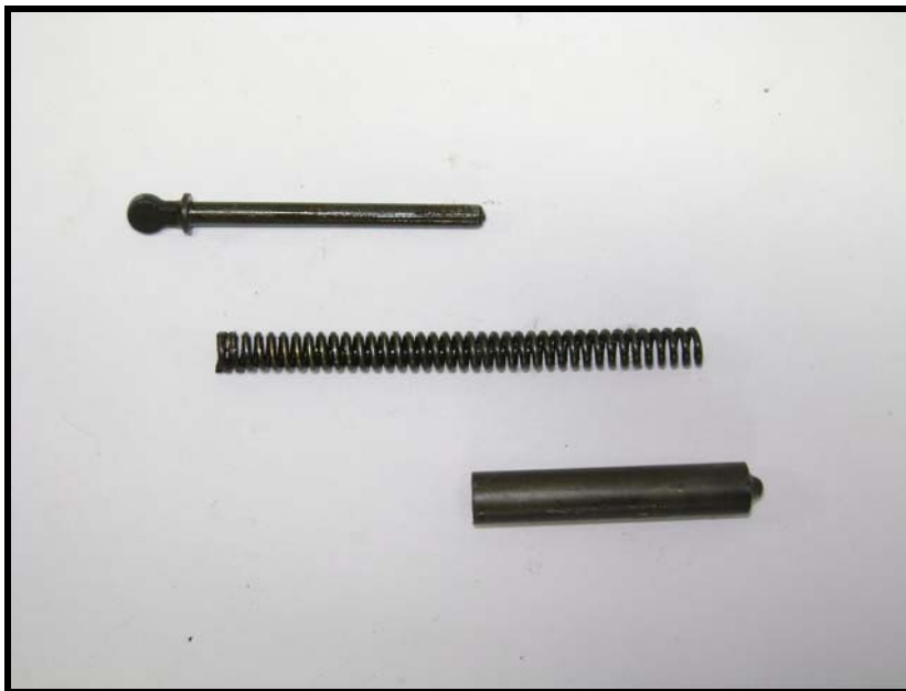
Fig 3.78 - Haste-guia, mola e estojo da mola do martelo
