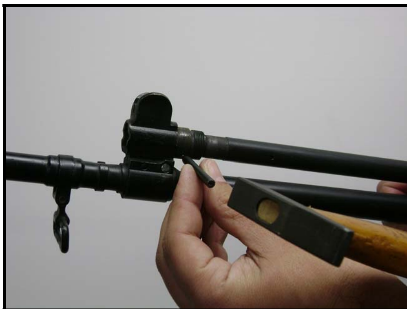
Fig 3.36 - Modo de retirar o pino do cilindro de gases.
