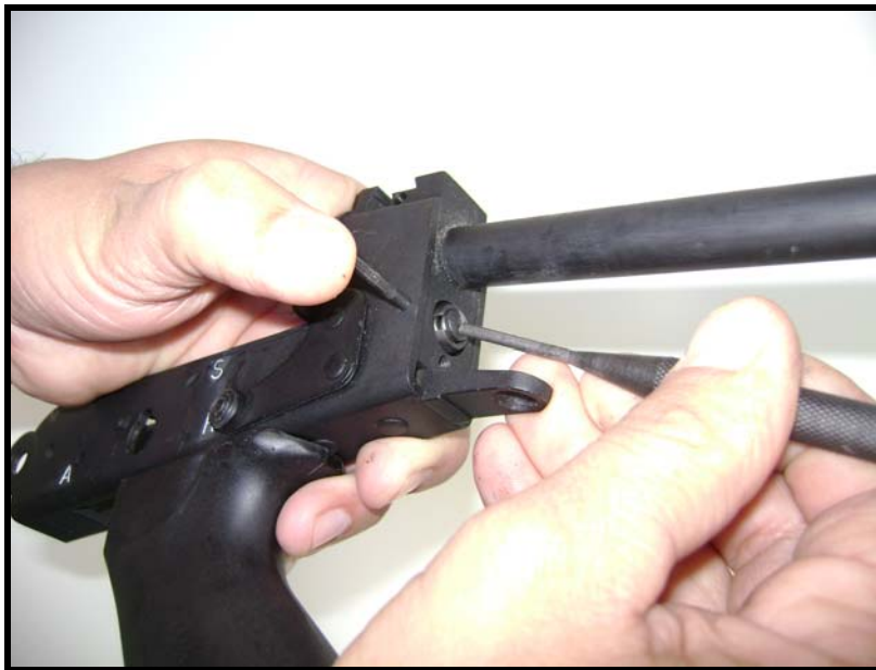
Fig 3.114 - Modo de comprimir a mola e colocar o toca-pino no alojamento do pino-guia
