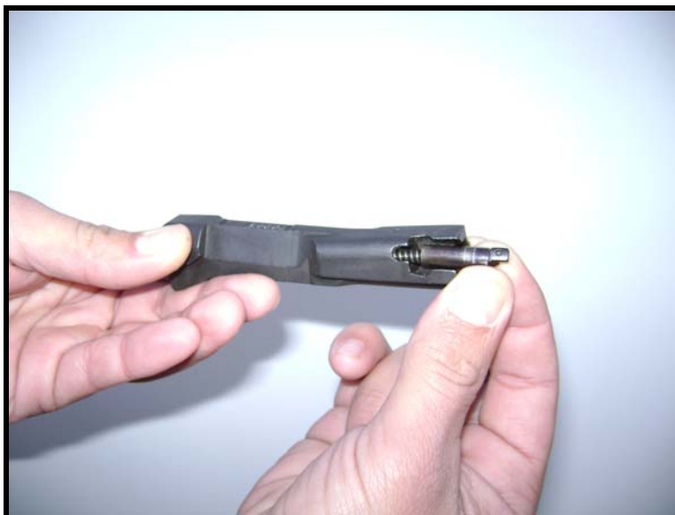
Fig 3.28 - Retirada do impulsor do extrator e da mola com seu amortecedor
