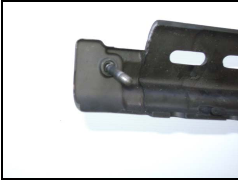
Fig 3.30 - Parafuso do guarda mão em seu alojamento
