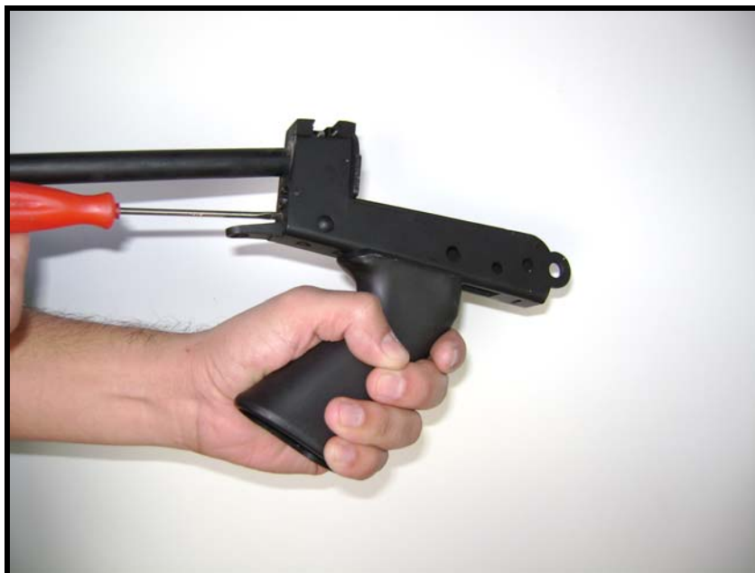
Fig 3.103 - Retirada do parafuso-suporte da chave do trinco da armação
