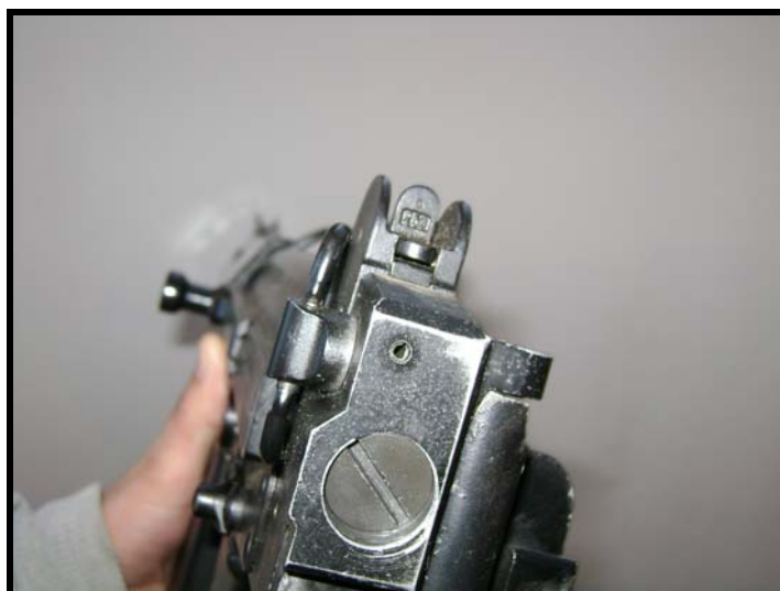
Fig 7.3 - Alça de mira basculante
