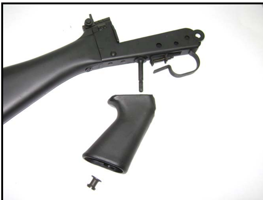
Fig 3.89 - Retirada da porca e do punho
