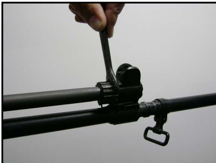
Fig 3.32 - Uso da chave especial para desparafusar o anel regulador do escape de gases
