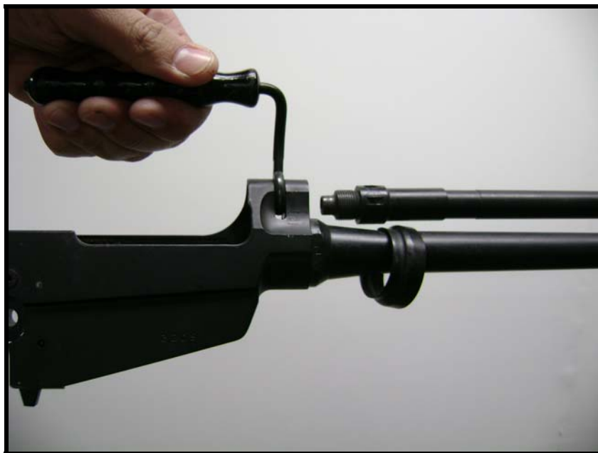
Fig 3.39 - Modo de retirar a alça de transporte
