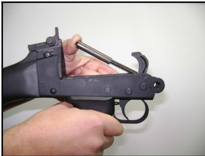
Fig 3.116 - Montagem e recolocação do impulsor do martelo
