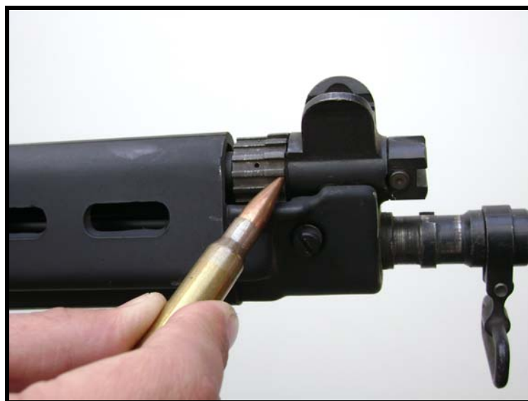
Fig 3.7 - Uso de um cartucho para girar o anel regulador
