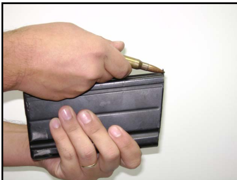
Fig 3.108 - Retirada do fundo do carregador com o auxílio de um cartucho
