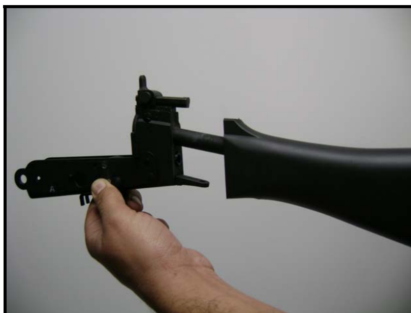
Fig 3.102 - Separação da coronha da armação
