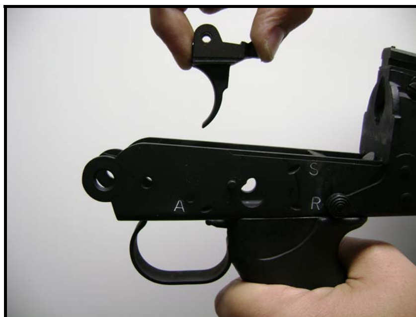
Fig 94 - Retirada do gatilho
