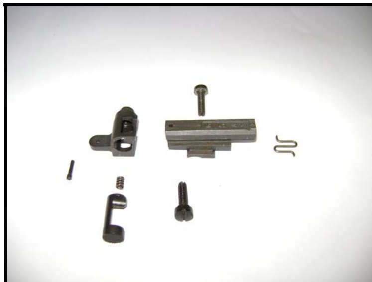
Fig 3.96 - Alça de mira desmontada: cursor, botão serrilhado, mola de botão serrilhado, corpo de alça e mola de travamento e mais ainda o pino limitador e o parafuso de correção da alça de mira
