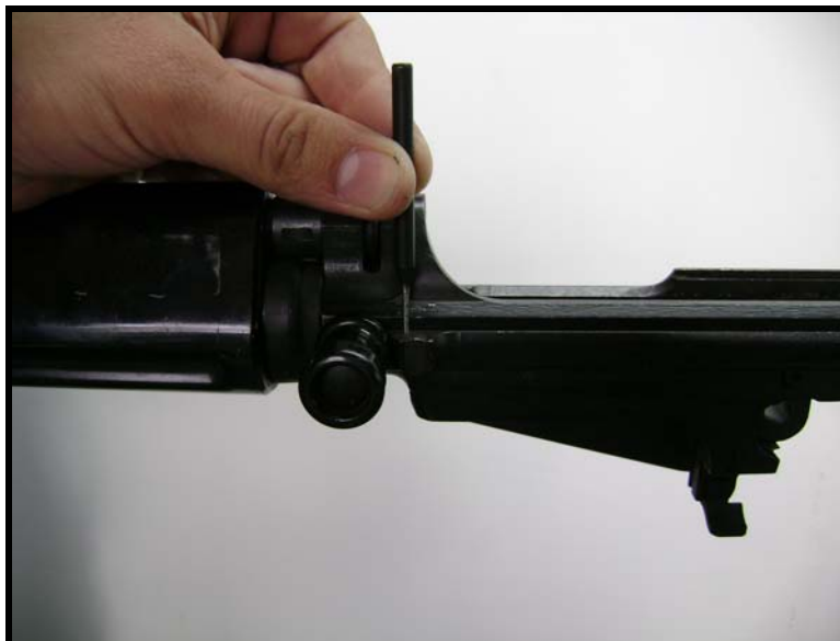
Fig 3.52 - Modo de retirar o pino da chaveta da alavanca de manejo
