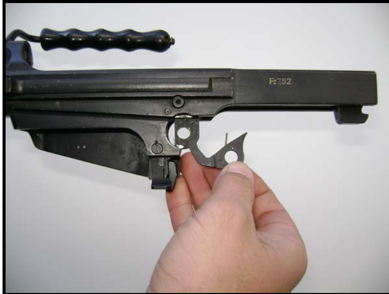
Fig 3.51 - Retirada do disparador do seu alojamento na caixa da culatra
