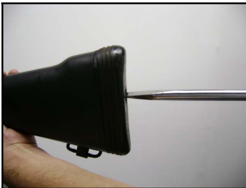
Fig 3.97 - Retirada do parafuso da chapa da soleira
