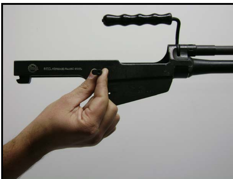
Fig 3.69 - Retirada do apoio do ferrolho
