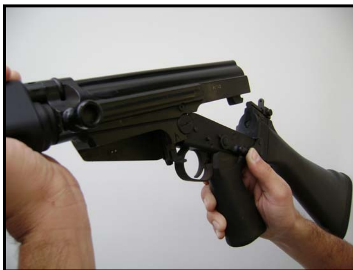
Fig 3.15 - Ação do polegar da mão direita sobre a chaveta do trinco da armação
