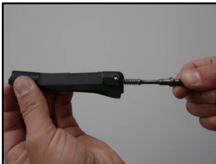
Fig 3.19 - Desmontagem do percussor
