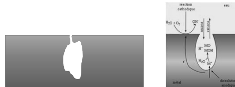
Corrosion par piqûre ( pitting corrosion )
