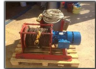
También puede instalarse uno o varios cabrestantes eléctricos ligeros (capacidad de carga 1,0Tn) en la plataforma de trabajo superior, para independizar la maniobra de subida de las armaduras u otros materiales, realizándola por el exterior de la construcción, evitándose así, interferencias en el trabajo (Fig.3/Posic.14).
