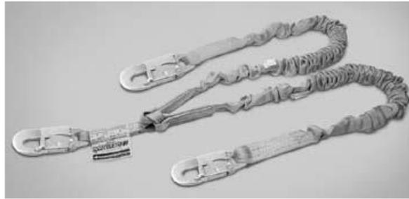
El cabo de anclaje doble conecta el arnés con los aparatos de ascenso, descenso o directamente a una estructura (Ver fig. 5). En general deberán cumplir la norma UNE-EN-354:2002, OSHA sub-parte M y ANSI Z359.
