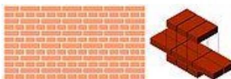
Aparejo Alternando las Hiladas con Disposición Tizón y Soga.
